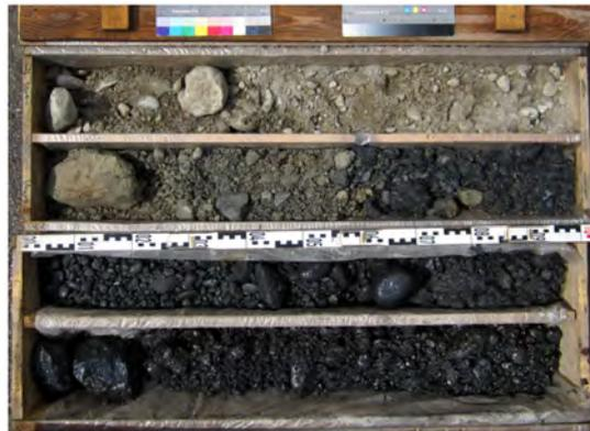
Abbildung 3.5: Bohrkiste mit Bohrkernen aus dem kontaminierten Bereich [4]
