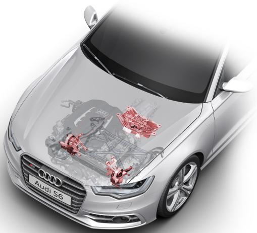
Abb. 3.2: Anordnung der Aggregatelagerung.<sup>1</sup>
