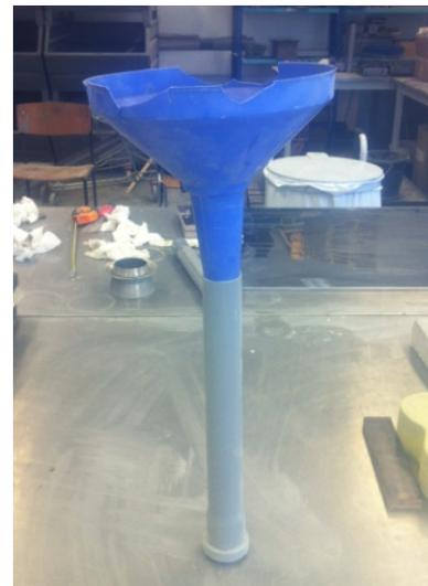
Abb. 54: Plastikrohr welches mit der Mörtelsuspension befüllt wurde
