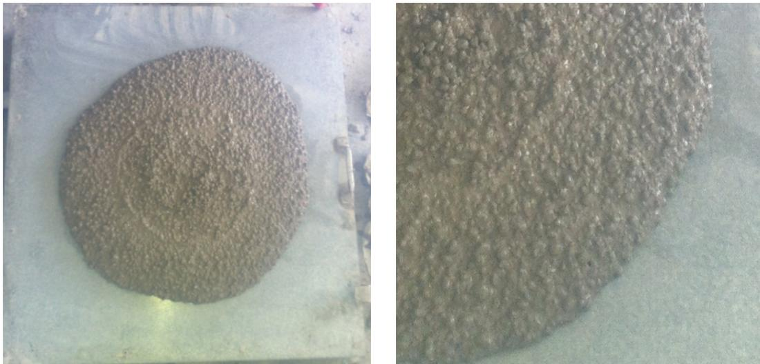
Abb. 62: Ausbreitkuchen des zwölften Betonversuchs
