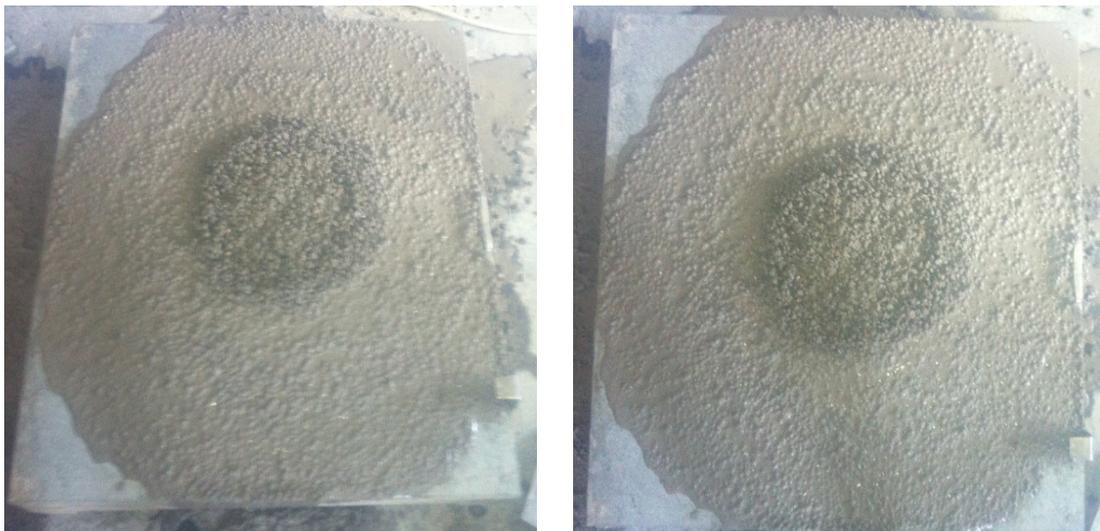
Abb. 59: Ausbreitkuchen des siebenten Betonversuchs
