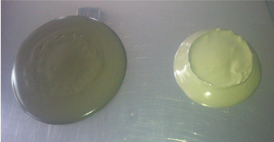
Abb.36: Ausbreitmaß Flugasche und Kalkmehl
