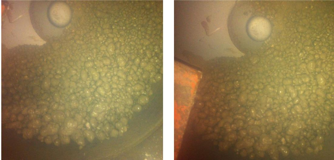
Abb. 70: Granulierter Beton in der Mischmaschine
