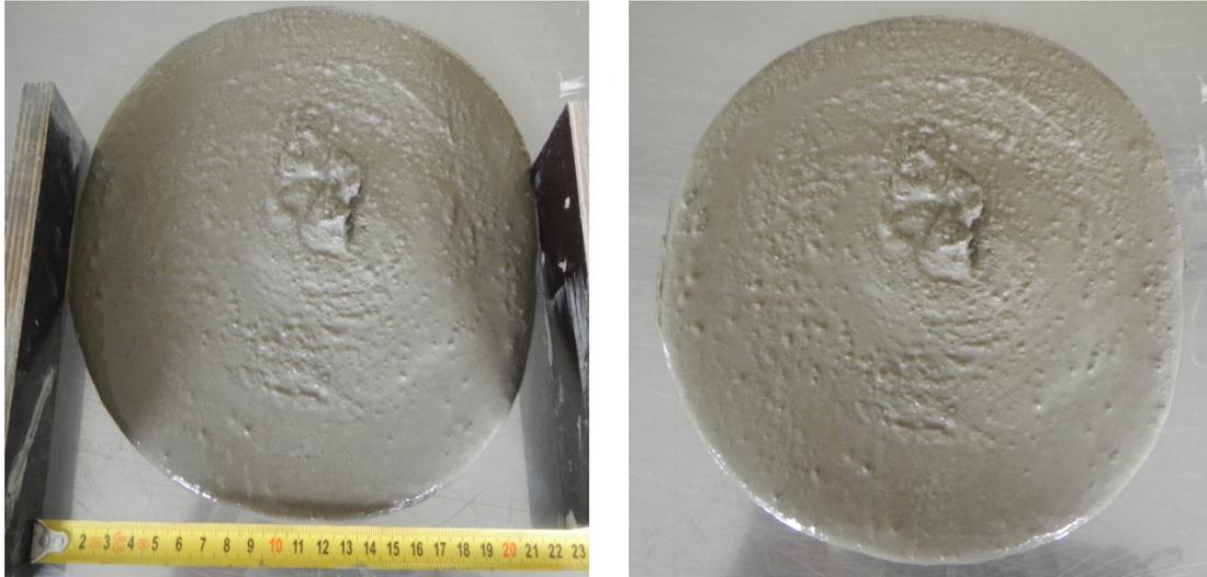
Abb. 47: Ausbreitkuchen des fünften Mörtelversuchs
