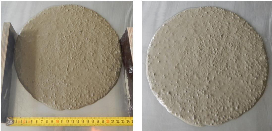
Abb. 53: Ausbreitkuchen des elften Mörtelversuchs
