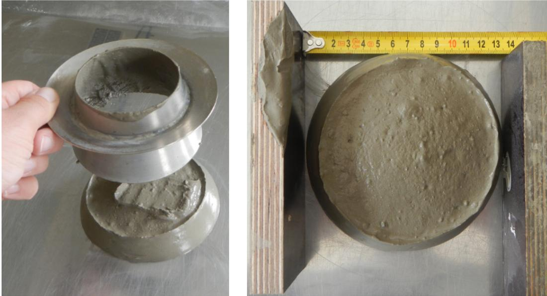
Abb.7: links: Austritt des Leims oder Mörtels; rechts: Messung des Durchmessers
