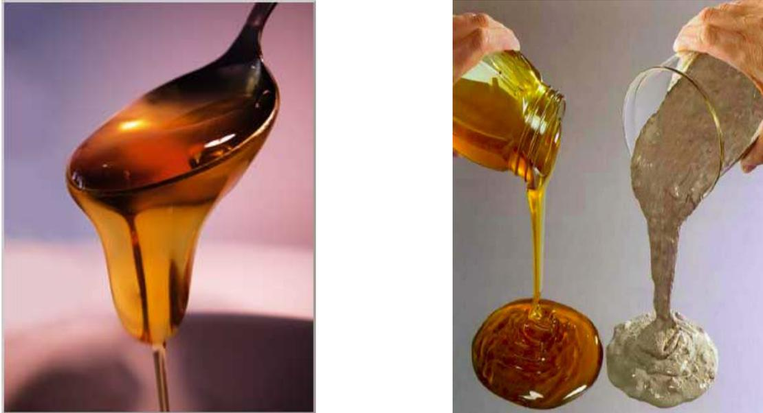
Abb.1: links Honig beim fließen [12], rechts Gegenüberstellung von Honig und SVB Beton [9]
