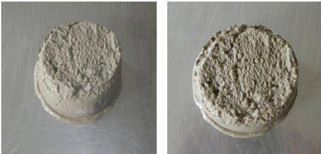
Abb. 43: Ausbreitkuchen des ersten Mörtelversuches
