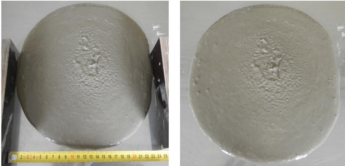
Abb. 49: Ausbreikuchen des siebenten Mörtelversuchs
