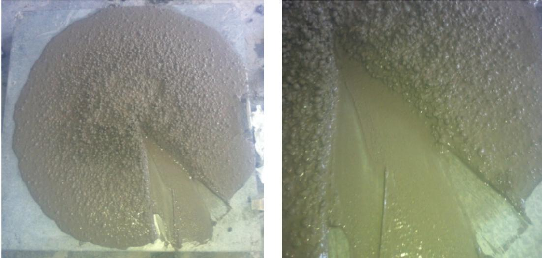
Abb. 61: Ausbreitkuchen des elften Betonversuchs
