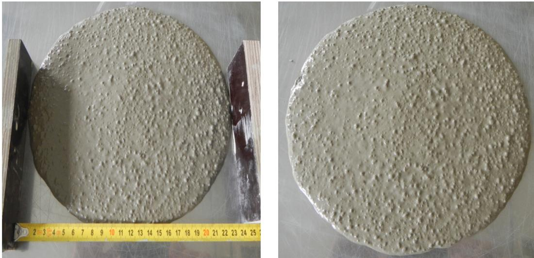
Abb. 52: Ausbreitkuchen des zehnten Mörtelversuchs
