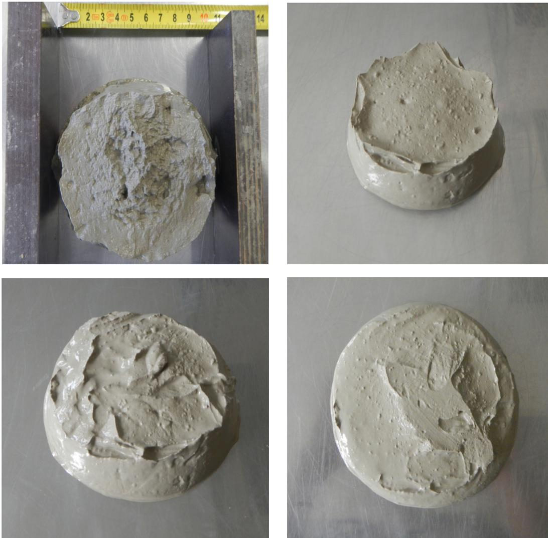
Abb. 31: Ausbreitkuchen der ersten vier Versuche der ersten Versuchsreihe
