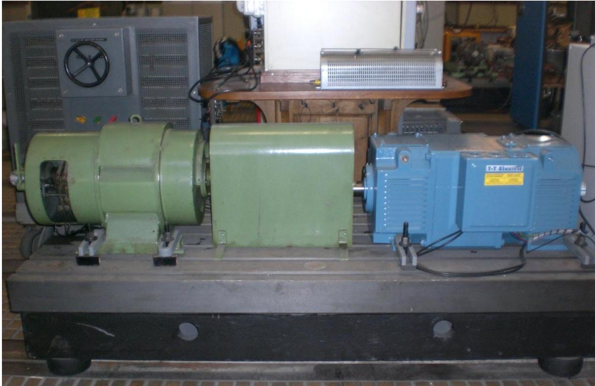
Abbildung 4.1: Prüfstandsanzordnung (grün: doppelgespeiste Asynchronmaschine; blau: Lastmaschine (GSM))
