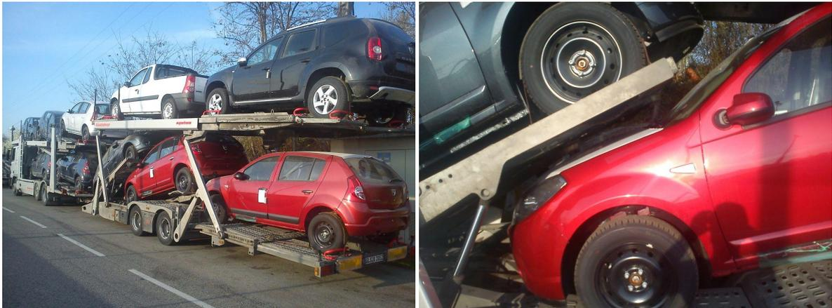
Abb. 41: Gestapelter Transport unter Ausreizung der Mindestabstände<sup>163</sup>
