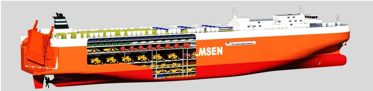
Abb. 49: Die MV Tønsberg der skandinavischen Reederei Wallenius Wilhelmsen Logistics (W&W) ist mit einer Kapazität von 5990 PKW<sup>182</sup> einer der derzeit größten RO/RO-Autotransporter<sup>183</sup>
