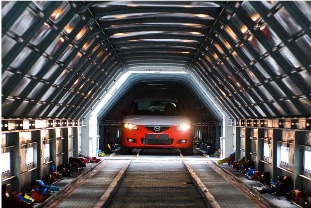
Abb. 53: Geschlossene Waggons mit eigens konstruierten Verankerungssystemen der Transsibirischen Eisenbahn<sup>188</sup>
