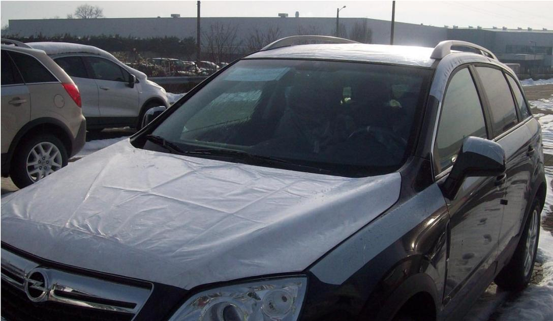
Abb. 50: Transportschutzfolien am Opel Antara (Hödlmayr-Compound, Graz)<sup>184</sup>
