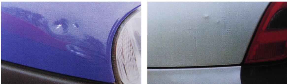
Abb. 14: Dellen (links) versus Beulen von innen nach außen (rechts)<sup>106</sup>
