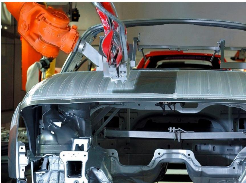
Abb. 60: Auftragen der Flüssigfolie auf Audi A3-Karosserie in Ingolstadt<sup>219</sup>
