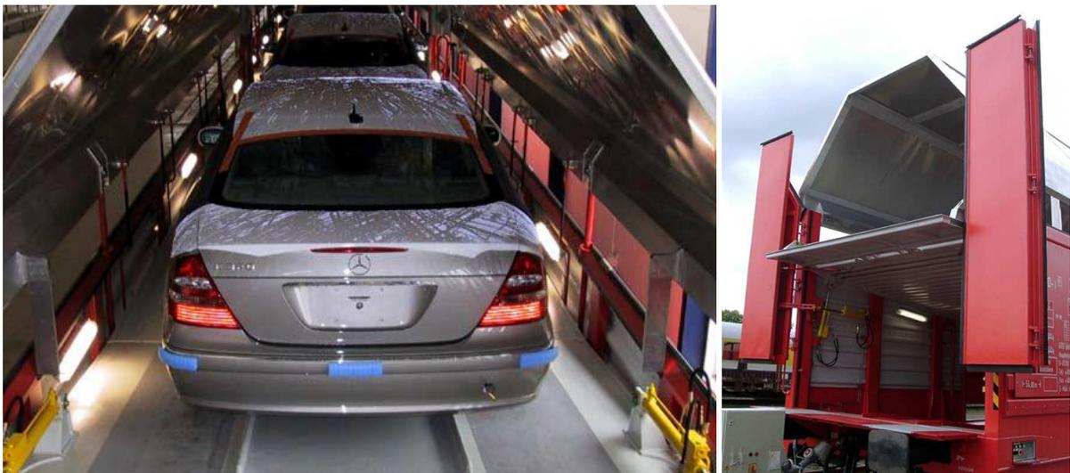
Abb. 51: Geschlossener Autotransportzug auf zwei Ebenen und ohne Witterungseinflüsse<sup>185</sup>
