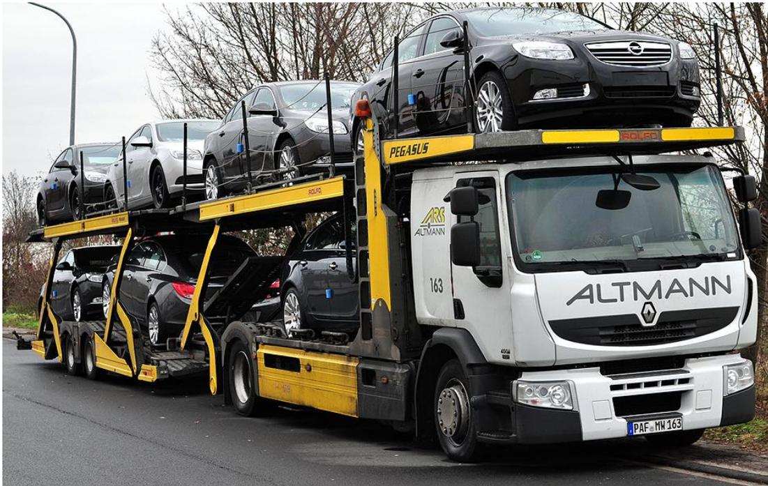
Abb. 9: Renault 450 DXi Euro5 Autotractor der Spedition ARS Altmann AG Automobillogistik mit Aufbau und Anhänger der Firma Rolfo S.P.A. sowie geladenen Opel Insignias<sup>69</sup>
