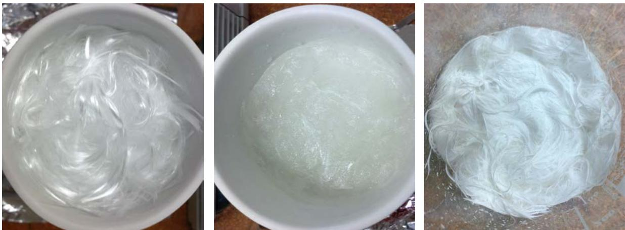
Abbildung 4.17: Imprägnierung der losen Glasfasern
