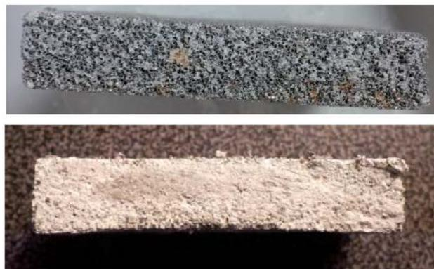
Abbildung 4.26: Metallschaum nach Imprägnierung mit  $\text{CaCl}_2$
