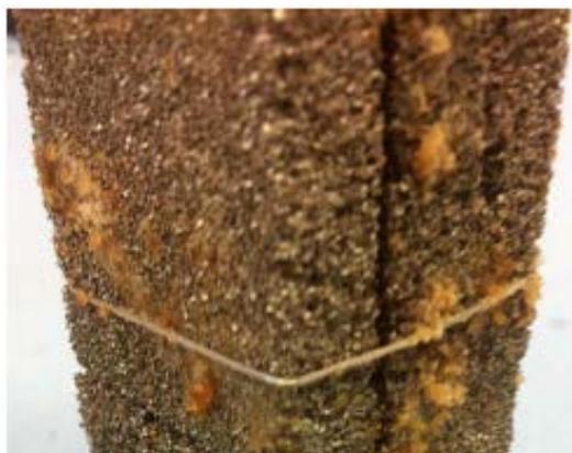
**Abbildung 4.31: Austritt von Salz aus der Struktur des Edelstahlschaumes nach Dehydrierung im Versuchsspeicher**
