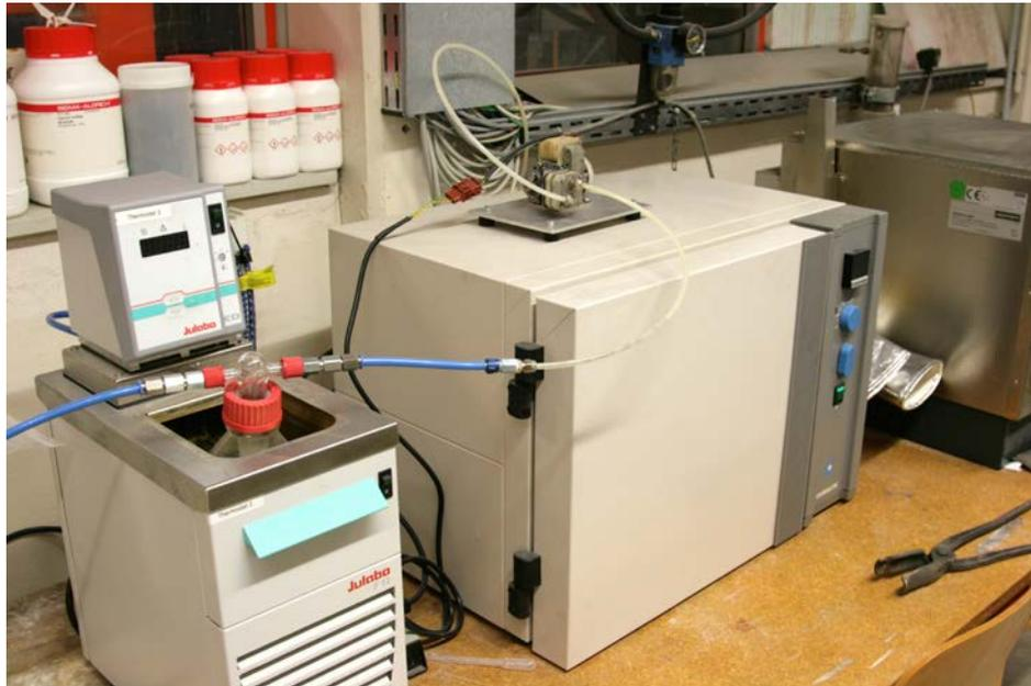
Abbildung 4.3: Trockenofen und Kühlfalle
