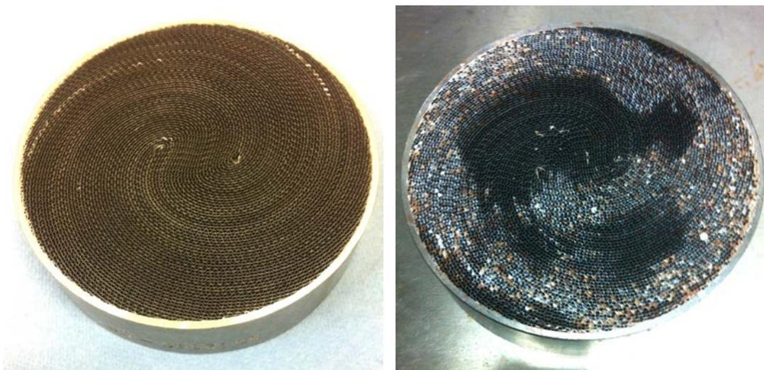
**Abbildung 4.32: Aluchrom-Substrat vor (li.) und nach (re.) der Imprägnierung**
