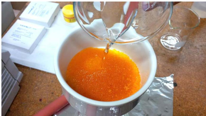
Abbildung 4.5: Tränkung von Silikagel mit einer  $\text{CaCl}_2$ -Lösung
