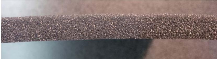
**Abbildung 4.33: Querschnitt Kunststoffschaum**
