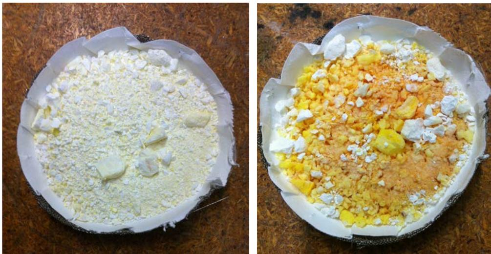
**Abbildung 4.35: Natriumsulfid vor (li.) und nach (re.) der Hydratation**
