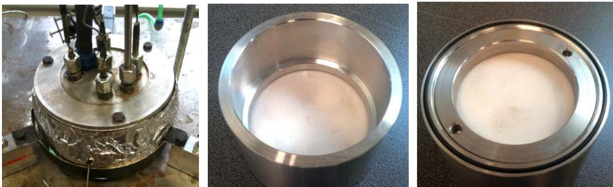
Abbildung 4.8: Reaktor (links), Reaktorbett (mitte) und Einsatz (rechts)
