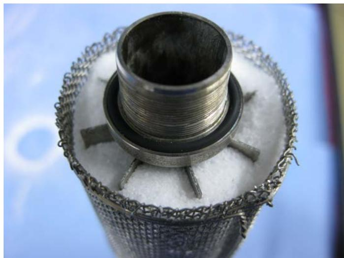
**Abbildung 4.20: Speicherelement mit  $\text{CaCl}_2$**
