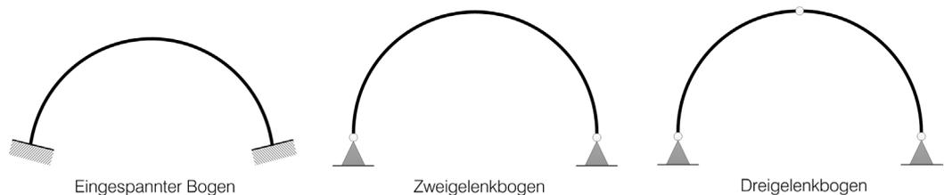
ABB.16 System Bogentragwerke
