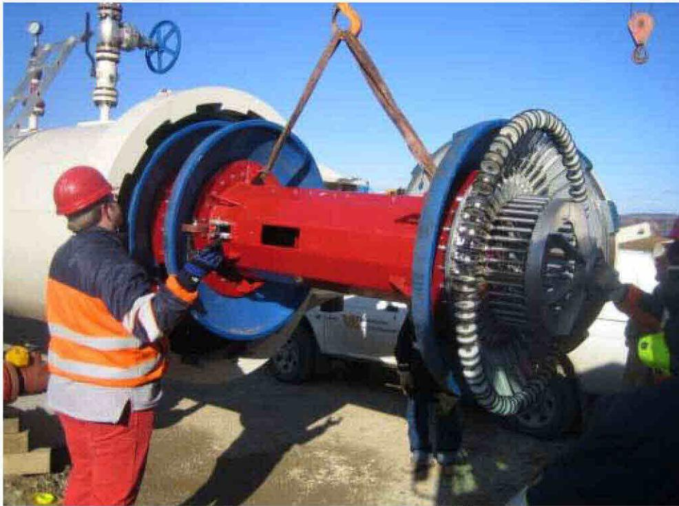
Abb. 5.16: Geometriemessmolch<sup>97</sup>
