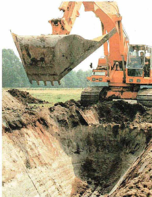
Abb. 5.10: Raupenbagger mit Profillöffel<sup>86</sup>
