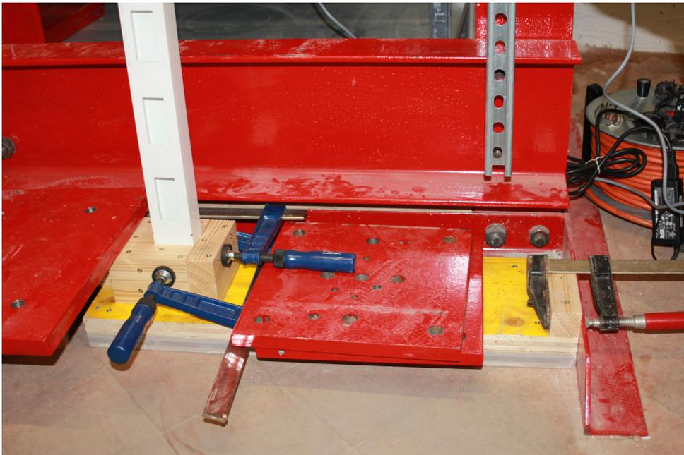
Abbildung 6.1: Einspannung und Fixierung der Grundplatte
