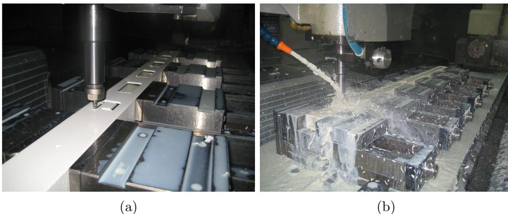
Abbildung 5.2: Herstellung der Profile: (a) Fräsvorgang Profil 1, (b) Kühlmiteileinsatz
