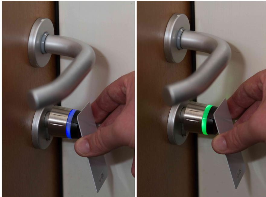
**Abbildung 2.4:** Überprüfung des Schlüssels auf der Karte (links); Erfolgreiche Überprüfung, Tür geöffnet (rechts)
