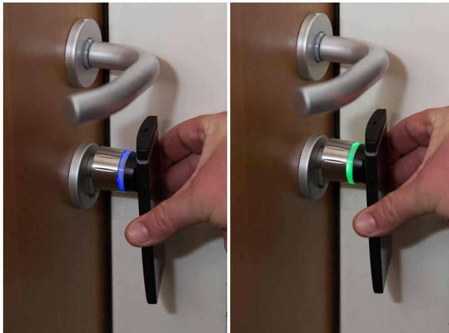
**Abbildung 2.5:** Überprüfung des Schlüssels auf dem Smartphone (links); Erfolgreiche Überprüfung, Tür geöffnet (rechts)
