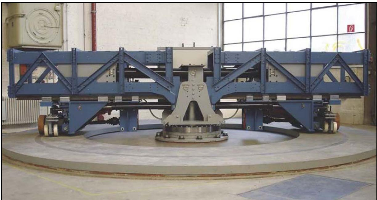
**Abbildung 4: Prüfstand der TU Stuttgart für Räder von Flurförderfahrzeugen (M. SCHRÖPPEL, M. WEBER, C. VORWERK, 2009, S. 80)**
