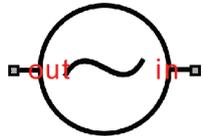
Die Komponente `msource_HE_Test.ssc` dient zur einfachen Vorgabe eines Fluidmassenstroms. Um damit vorzeichenrichtig zu rechnen, muss der Eingabewert positiv sein und beim Einbau auf die Flussrichtung geachtet werden. Druck und Temperatur bleiben beim Durchlaufen des Blockes konstant. Verwendung findet dieser im Heißwasserkreislauf des ORC-Prozesses.
