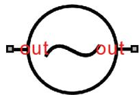
Der Simscape Block `Tsource_HE_Test.ssc` gibt die eingegebene Temperatur an beide Knoten aus, also in beide Richtungen. Der am Eingang anliegende Druck passiert die Komponente unverändert. Eingebaut ist dieser Block sowohl im Thermoöl- als auch im Heißwasserkreislauf.
