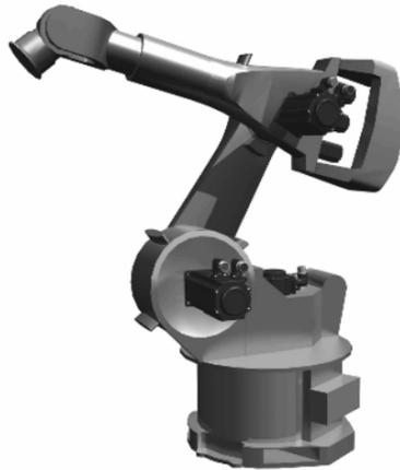
*Abbildung 2: Prinzipdarstellung eines Knickarmroboters [2]*
