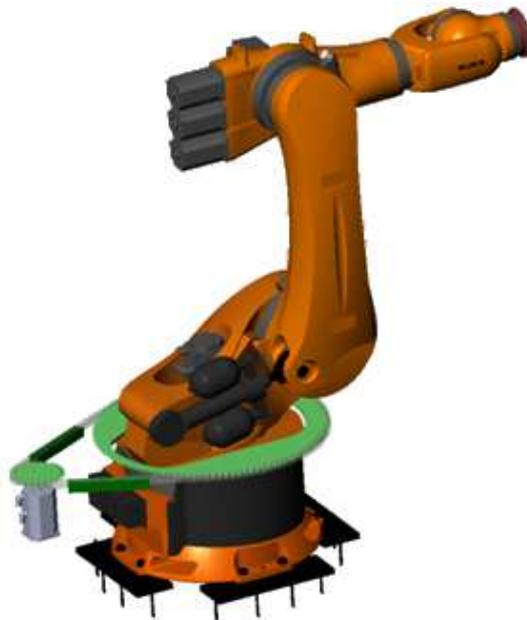
Abbildung 18: Roboter mit Kettentriebvorspannung
