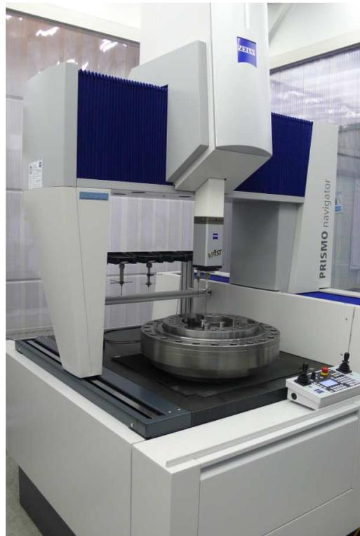
Abbildung 28: Koordinatenmessmaschine bei Getriebevermessung
