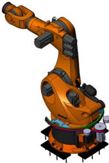
Abbildung 16: Roboter mit Riementriebkonzept
