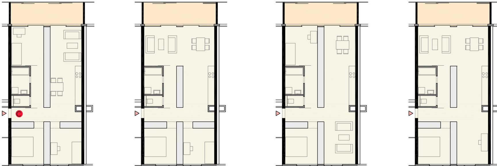
Abb. 63: Anwendungsbeispiel modulares Schrankwandssystem: Varianten am Beispiel Bestand 2: Typ C
