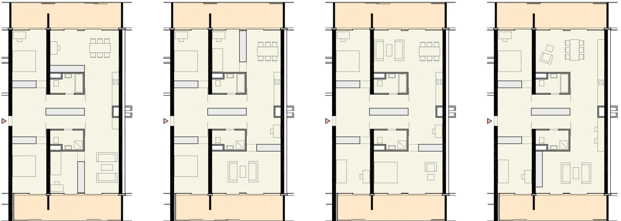
Abb. 74: Anwendungsbeispiel modulares Schrankwandsystem: Typ B - Varianten Regelgeschoß
