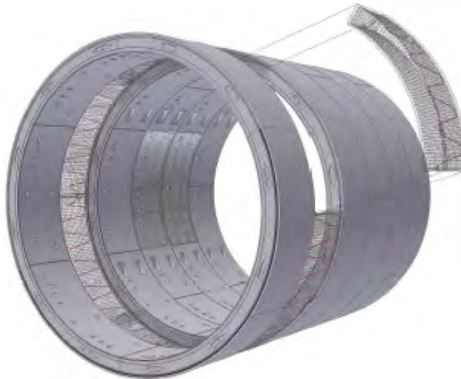
Abbildung 4.28: Energietübbing<sup>171</sup>
