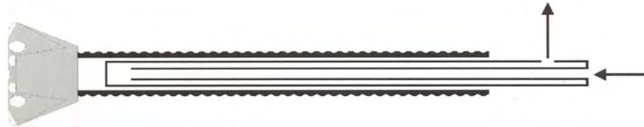
Abbildung 4.25: Energieanker mit eingeführter Koaxialsonde<sup>167</sup>
