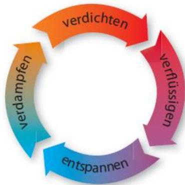
Abb. 4. 4: Kreisprozess einer Wärmepumpe [41]
