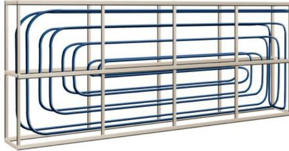
Abb. 3. 7: Schema eines Gitterkollektors [38]
