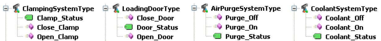
Abbildung 3.3: Objekttypen der Hilfsantriebe
