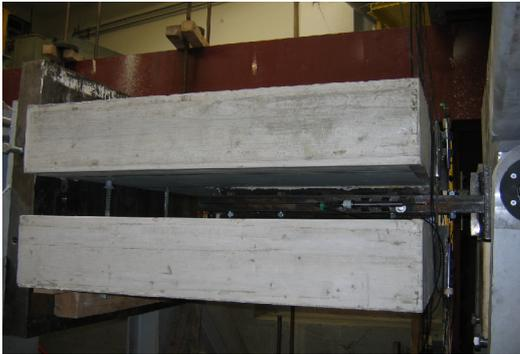
Abb. 1.5: Push-Out Versuch lt. EC 4 (aus [3])
