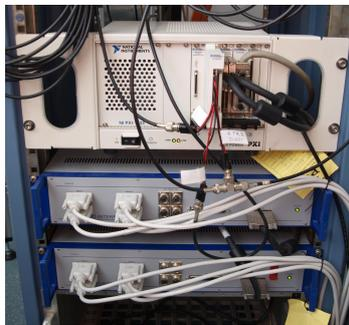
Abbildung 4.8: PXI Chassis und Motion I/O Interfaces.
