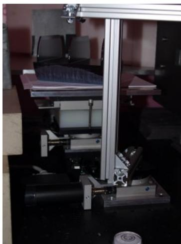
Abbildung 4.11: IFM mit Stellmotoren. Im Vordergrund ist der Drehmotor für den Phasenschieber zu sehen, im Hintergrund die Steuereinheit für das IFM.
