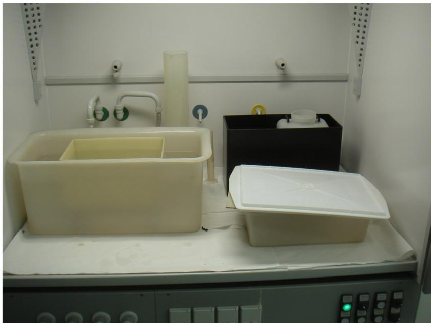
Abbildung 3.1: Ätzplatz unter dem Luftabzug mit Ätzwanne, Messbehältern, Aceton- und Dest.-Wasserbad.
