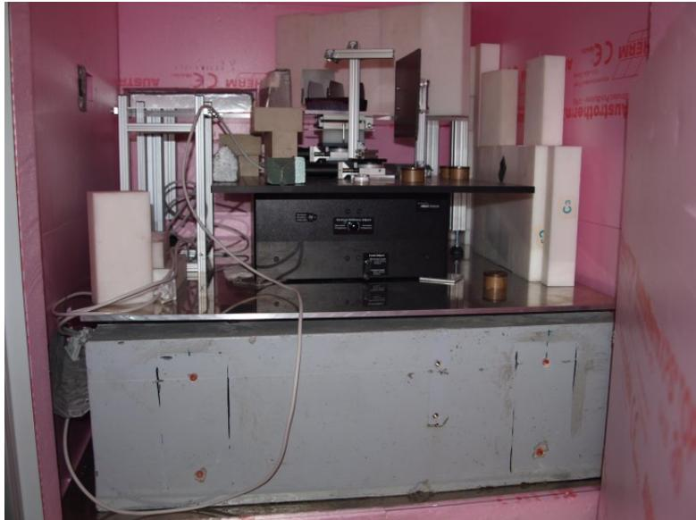
Abbildung 4.10: Innenleben des IFM-Hauses. ganz unten ist der Betonblock zu sehen, darauf eine nivellierte Aluminiumplatte, auf der der Antivibrationstisch steht. auf dem Tisch sind die Steuermotoren für das IFM, die Blende und der Phasenschieber montiert. Auf der rechten Seite befinden sich Parafinziegel zur Abschirmung von Untergrund.
