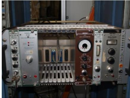
Abbildung 4.7: NIM-Rack mit Spannungsquellen.
