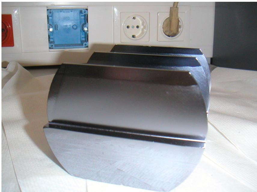
Abbildung 3.8: Man sieht deutlich die Spuren des partiellen Ätzens an den Oberkanten der Platten und links.
