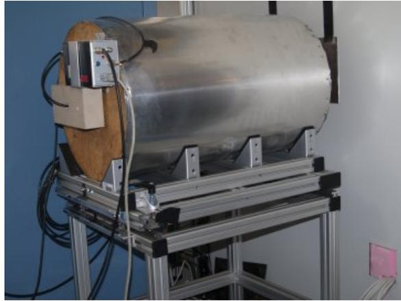
Abbildung 4.5: Detektortisch mit Abschirmung, Detektor und Vorverstärker.
