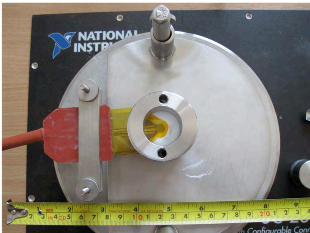
**Abbildung 4.16:** Probenpräparation: 1. Stahlzylinder mit Pulver befüllen und Sensor einspannen. 2. zweiten Stahlzylinder darauf setzen und wieder befüllen.
