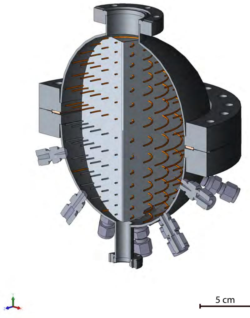
**Abbildung 3.6:** Gerendertes Schnitt durch den Kugeltank zum kontrollierten Ausgasen der Mikrogaskugeln
