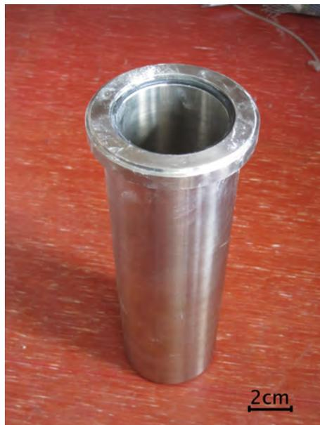
Abbildung 3.1: Stahltank zum Befüllen der Mikroglaskugeln
