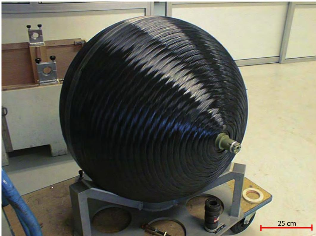
**Abbildung 2.5:** Speichertank aus thermoplastischen Material
