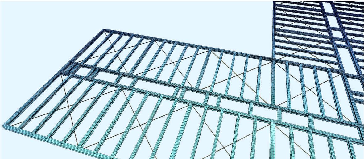
*Abb. 4.16: 3D-Darstellung, Detail Auswechslung; L-Grundriss; Trakttiefe 5,0m*
