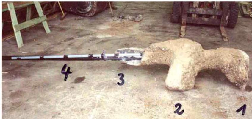
**Abb. 4.2:** Freigelegter Versuchsanker mit Nachverpressung über Manschettenrohr; aus [28]
