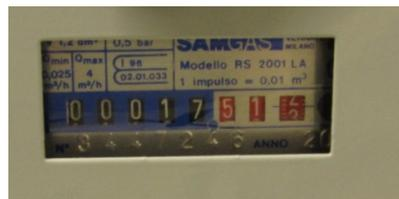
**Abbildung 3.40:** Durchflussvolumenzähler der Pumpe
