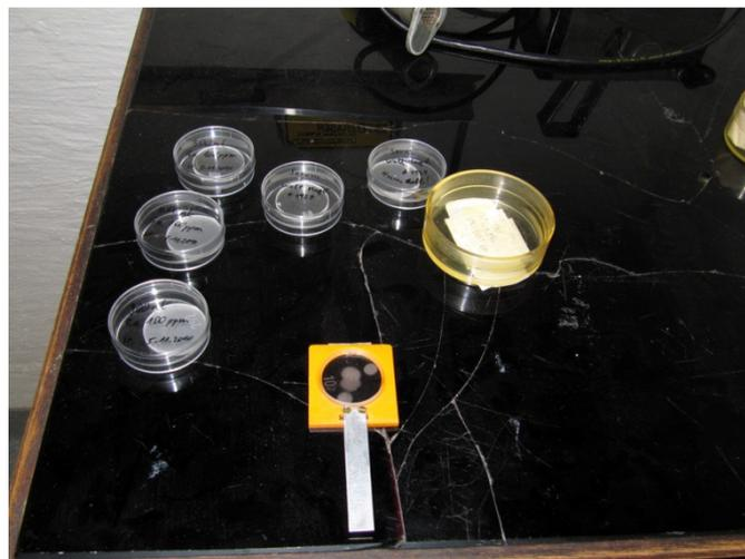
**Abbildung 3.4:** Probenträgerhalterung (unten mitte) und verschiedene Proben auf TXRF-Quarzreflektoren
