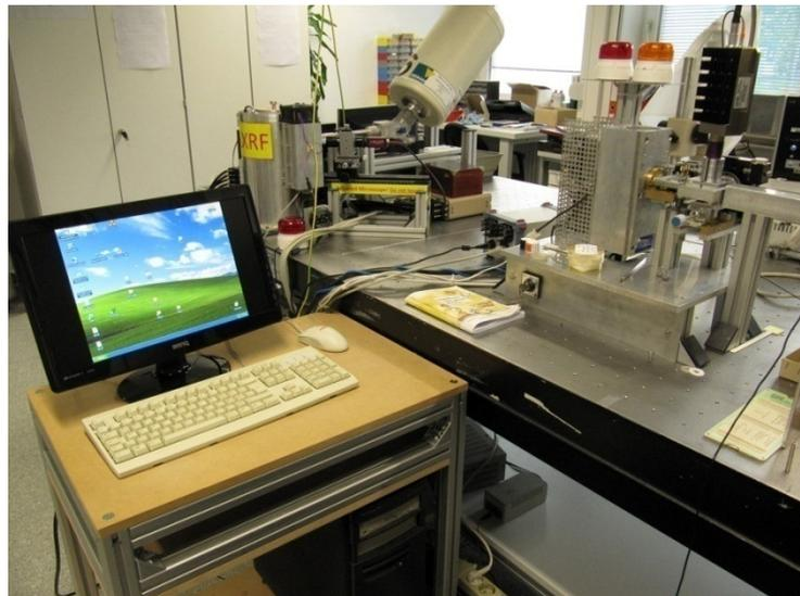
**Abbildung 3.18:** Low Power TXRF-Messplatz (Strahlenschutzhaube nicht aufgesetzt)
