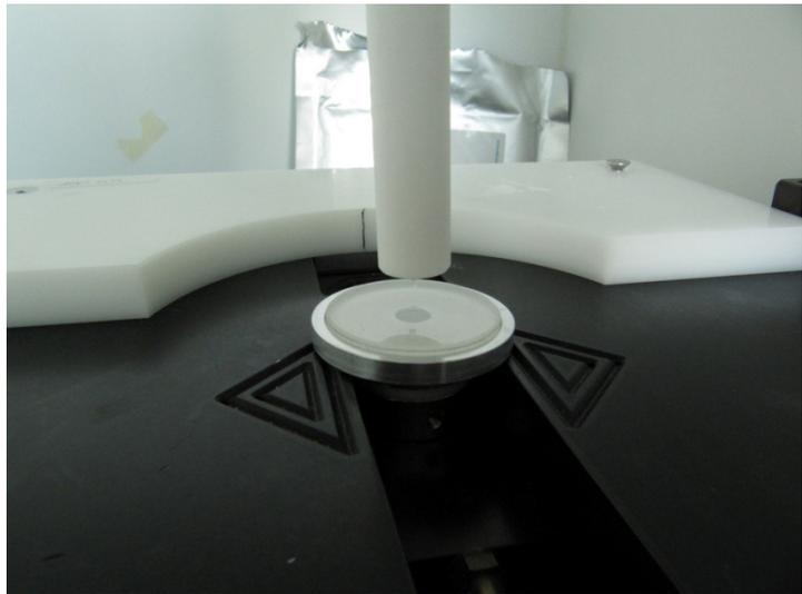
**Abbildung 3.30:** Probenträgerhalterung mit eingelegtem Quarzreflektor (links) – **Abbildung 3.31:** Reflektor auf Probenträgerhalterung in "HOME-Position", das PTFE-Röhrchen wird vom Führungszylinder geführt (rechts)
