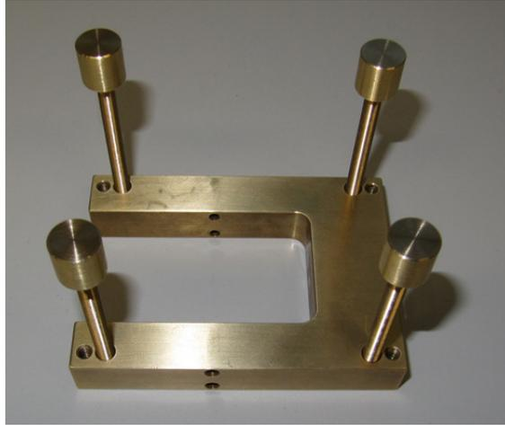
**Abbildung 3.13:** M5-Feingewindeschrauben für die Justierung des TXRF-Teils
