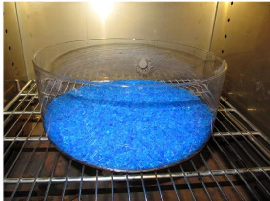
**Abbildung 3.43:** Wärmeschrank (links) – **Abbildung 3.44:** Silica-Gel nach Ausheizen (rechts)
