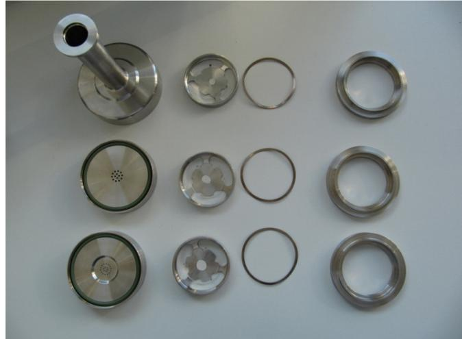
**Abbildung 3.34:** vollständig zusammengebauter Dekati PM10-Impaktor (links) – **Abbildung 3.35:** Bestandteile der einzelnen Stufen des Dekati-PM10-Impaktors (rechts)
