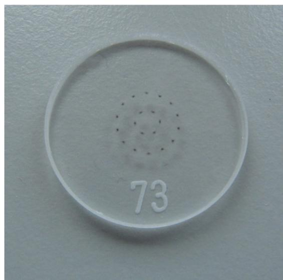
**Abbildung 3.37:** Impaktorstufe mit Quarzreflektor – **Abbildung 3.38:** auf Reflektor gesammelte PM1-Probe
