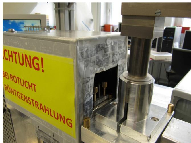
**Abbildung 3.12:** Mit Blei ausgekleidete Strahlenschutzhaube
