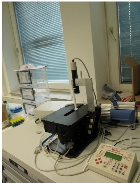
**Abbildung 3.32:** Nanoliter-Applikationseinheit (Skizze, links) – **Abbildung 3.33:** aktueller Aufbau (rechts)
