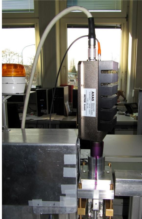
**Abbildung 3.6:** Ketek AXAS-M-100mm<sup>2</sup>-Detektor in Messposition
