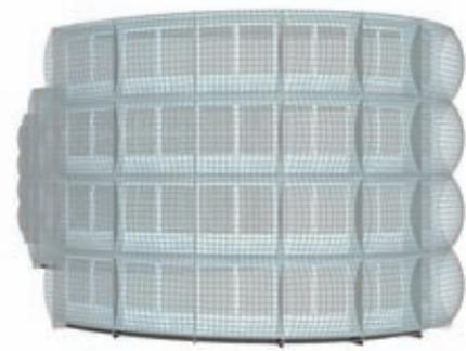
5) An der gesamten Gebäudeform entlang laufendes horizontales Pneu-Kissen (Unterdruck)
