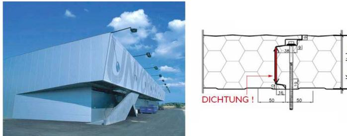
Abbildung 4.3: PU-Panel: Trevision Betriebsgebäude, querkraft Architekten; Brucha Systemschnitt
