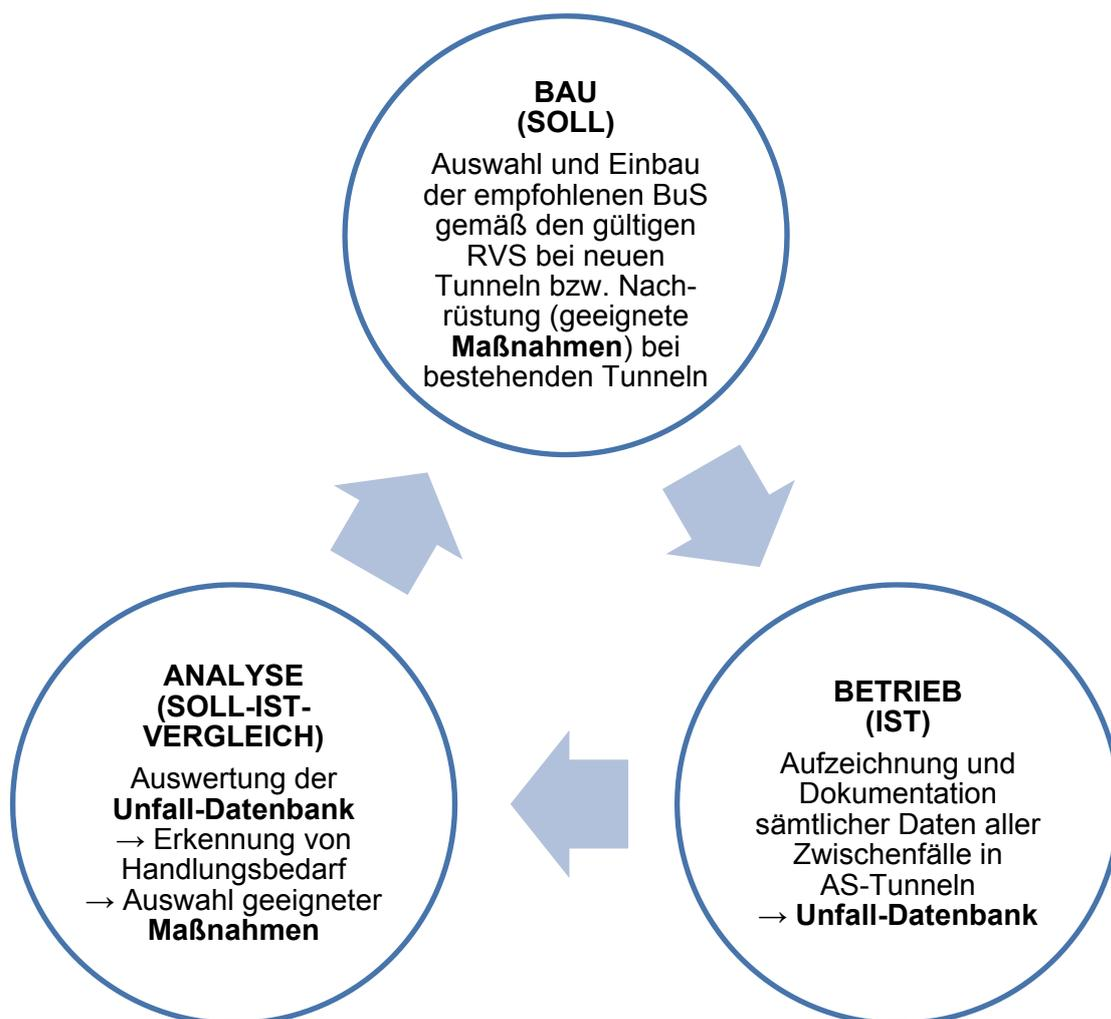
**Abb. 33:** Optimaler Ablauf zur gezielten und effizienten Verbesserung der Tunnelsicherheit
