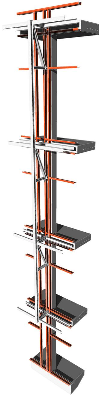
Abb. 6.27 Fassade \_ Tragstruktur Pfosten / Riegel
