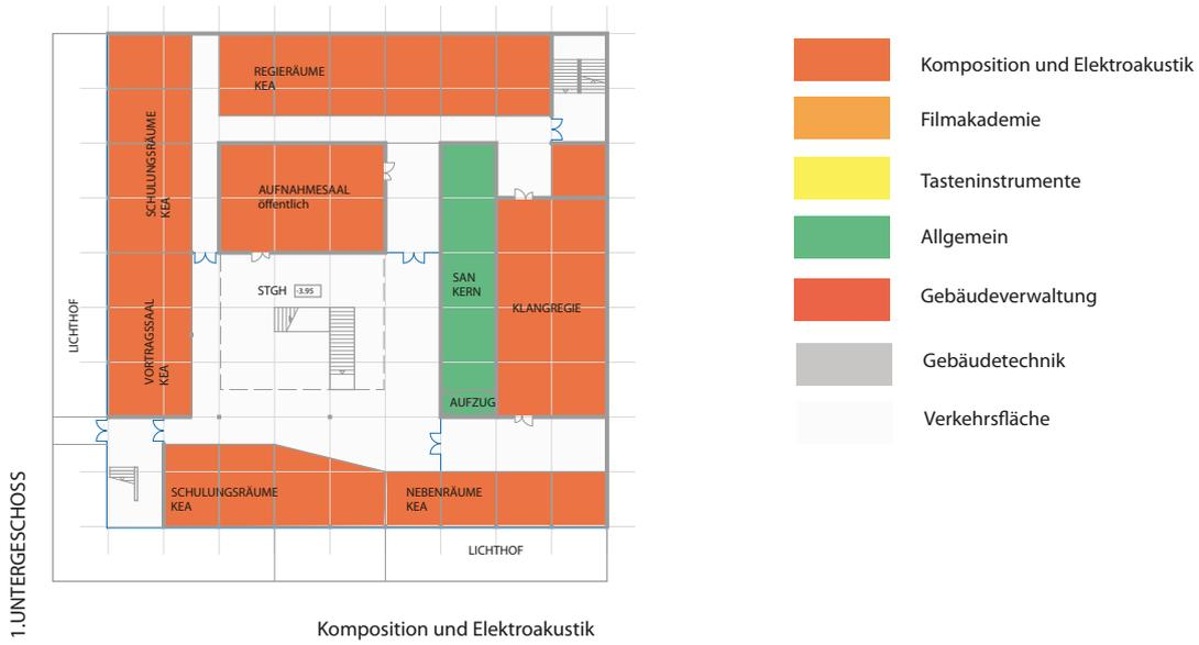
Abb. 5.05 Vorentwurf \_ Grundriss 1.UG
