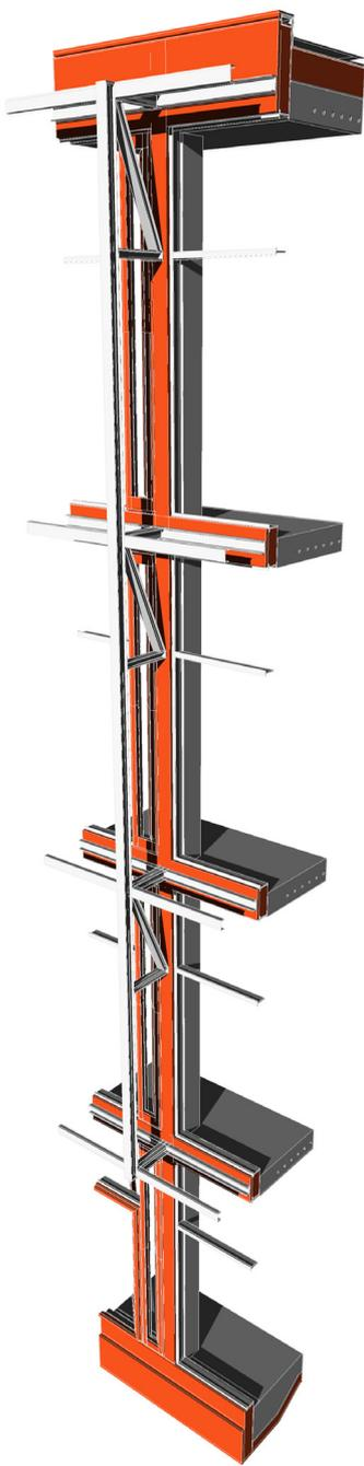
Abb. 6.29 Fassade \_ Wärmedämmebene
