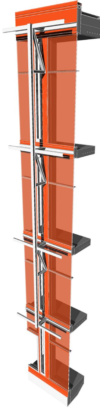
Abb. 6.30 Fassade \_ Verglasung / Lüftungselemente / Verblechung
