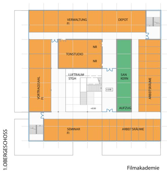
Abb. 5.03 Vorentwurf \_ Grundriss 1.OG
