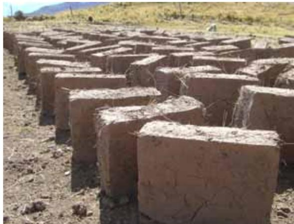
Abb 45: Zum Trocknen aufgelegte Lehmziegel
