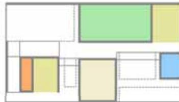
um einen schutz vor sonne und regen zu gewährleisten, wird ein flach geneigtes dach (9°) richtung norden über die verkehrsflächen zwischen die einzelnen baukörper gezogen. gleichzeitig entstehen so überdachte aussenräume, die unterschiedlich benutzt werden können. öffnungen im dach sollen für eine ausreichende belichtung der räume sorgen.
