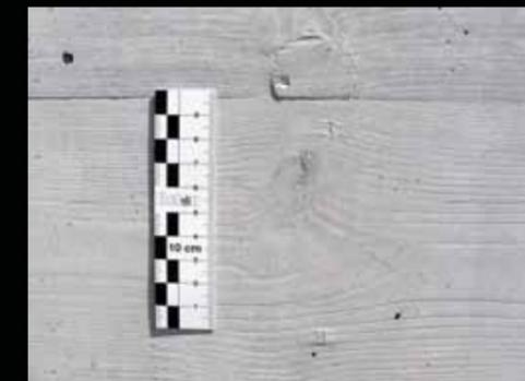
Abbildung 125: Betonoberfläche bei Verwendung einer saugenden Schalhaut
