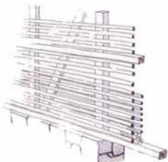
Abbildung 14: Holzskelettkonstruktion gefüllt mit „baskije“
