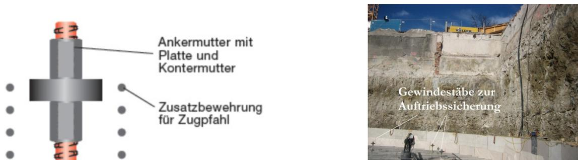
Abb. 66: Links: Kopfdetail eines Gewindestabs für Auftriebssicherungen aus [40] und rechts Auftriebssicherung mit Gewindestäben für die Fundierung aus [42]
