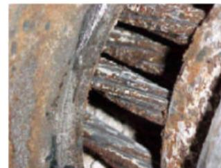
Abb. 20: Korrosionsschäden an Litzen, Rechts und Links Lochfrasskorrosion im Bereich des Ankerkopfs aus [16]
