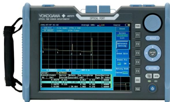
Abb. 45: Optical Time Domain Reflectometry – Analysegerät mit typischem Messergebnis aus [20]
