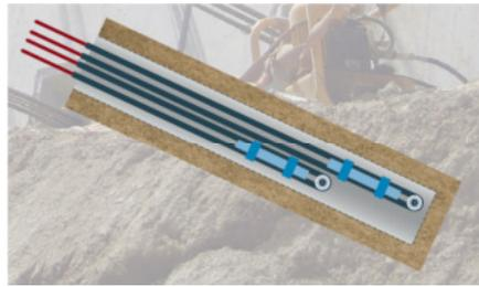
Abb. 12: Wiedergewinnbarer Litzenanker nach dem System der Firma Keller Grundbau GmbH bei dem die Litzen über einen Umlenksattel in Schlaufen im Bohrloch eingebaut werden, aus [42]
