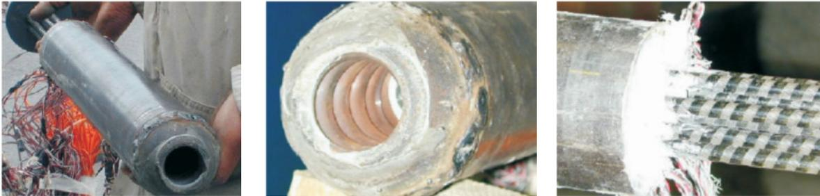
Abb. 57: Klebeverankerung für Stabquerschnitte links, Mitte: Vorderseite mit Stahlmuffe für den Spannvorgang, Rechts: Rückseite der Klebeverankerung aus [68]
