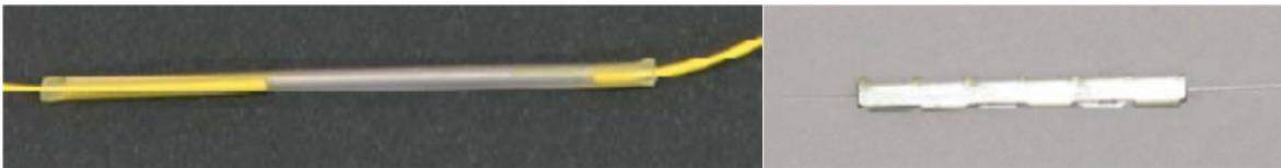
Abb. 43: Links: Schrumpfschlauch und rechts mechanischer Klipp als Schutzelemente für Splice- Verbindungen aus [20]
