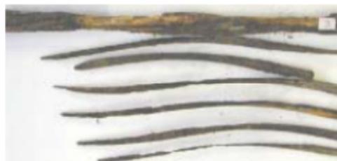
Abb. 67: Korrosion an einer Stahllitze nach 3 Jahren in stark alkalischem Baugrund, Anker musste komplett erneuert werden aus [39]
