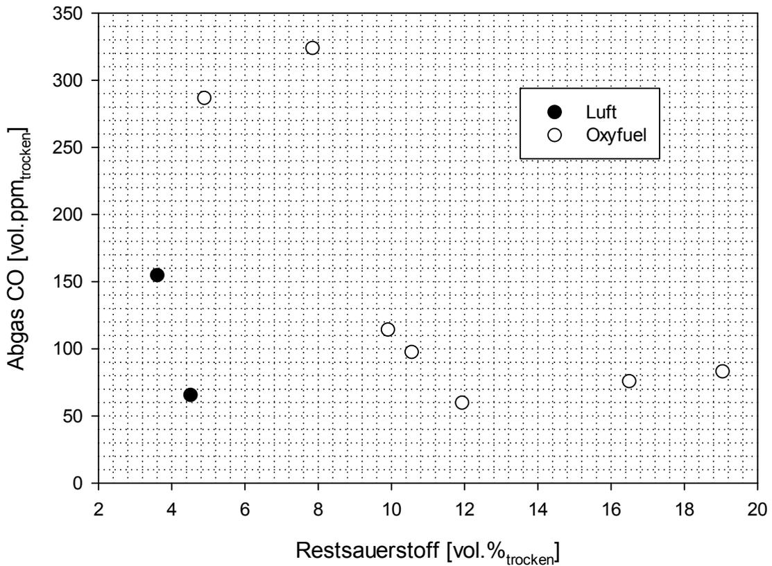
Abbildung 53 Kohlenmonoxid in Abhängigkeit des Restsauerstoffgehaltes im trockenen Rauchgas für Klärschlamm B
