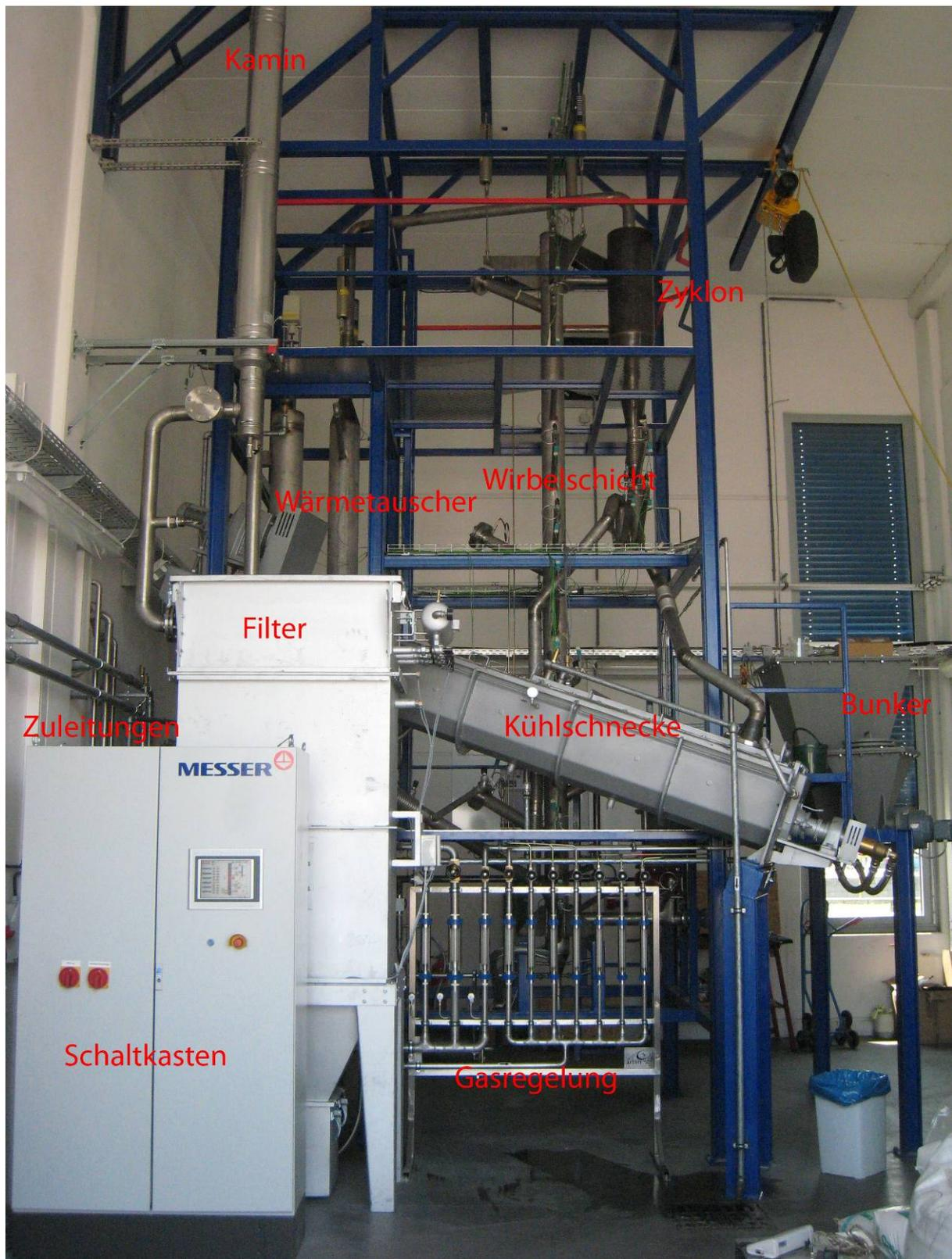
Abbildung 38 100 kW<sub>th</sub> Oxyfuel Versuchsanlage
