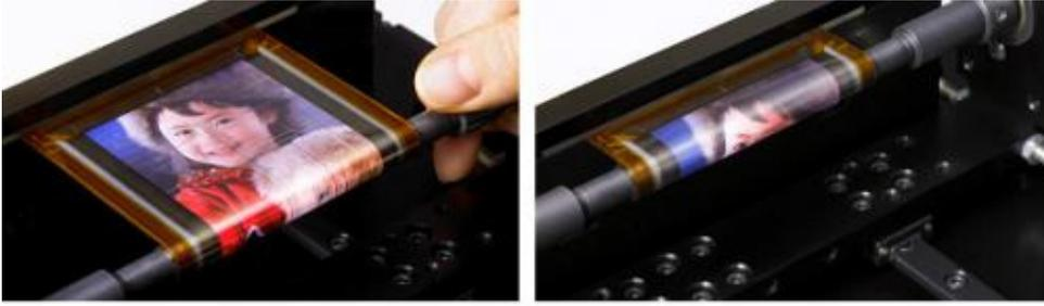
**Abb.B.1.1:** Flexibles OLED-Display, © Sony
