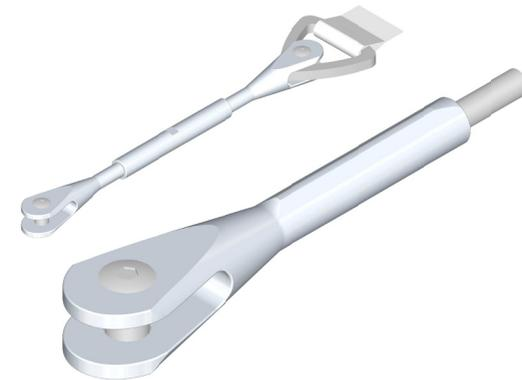
Auch die **diagonalen Spannseile** werden an ihren Enden mit Gabelfittingen verpresst. Für die Verbindung der jeweils äußersten Membranfläche mit dem Wandbeschlag wurde ebenso ein Gabelspannschloss gewählt.
