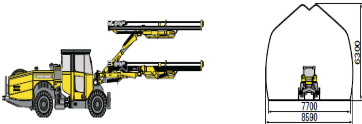
Abb. 11.1 Bohrwagen „Rocket Boomer M2 C“
