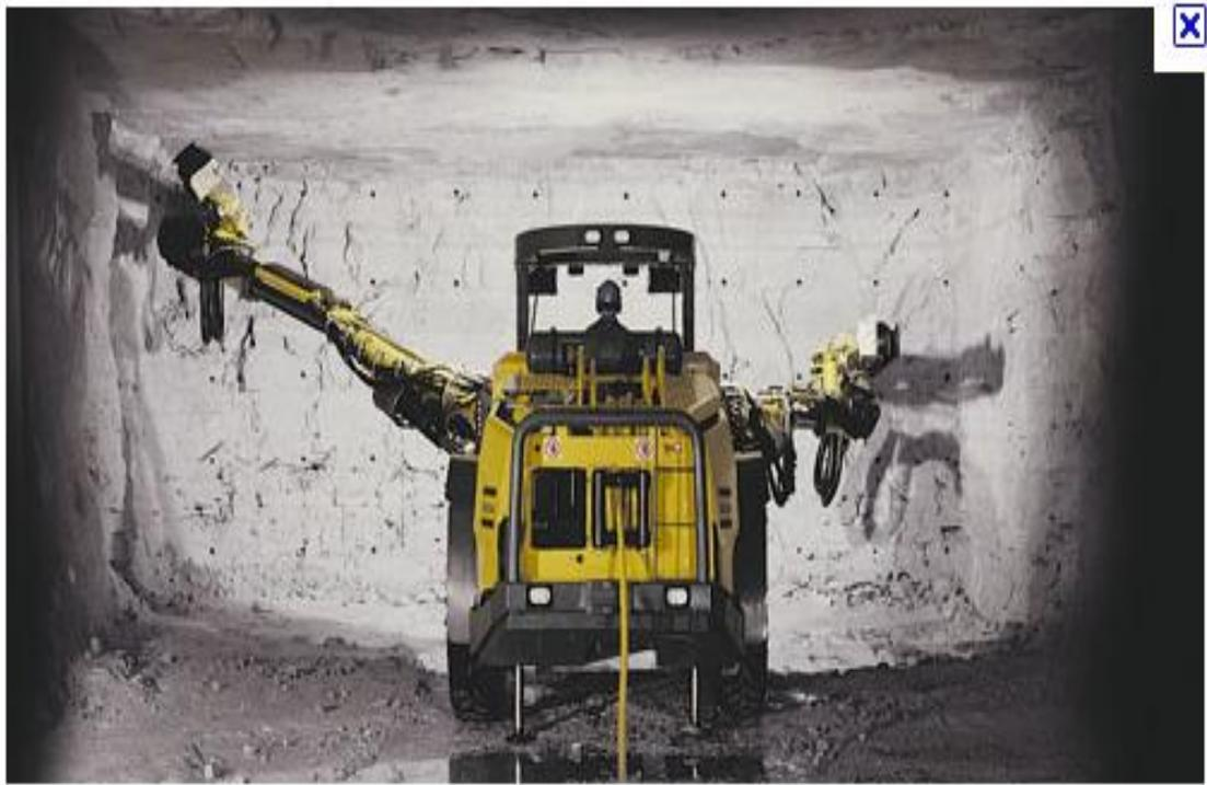
Abb. 11.2 zweiarmige Bohrmaschine „Rocket Boomer M2 C”
