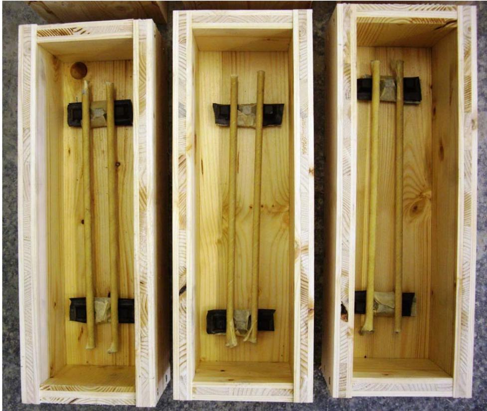
Abbildung 5.16: Biegezugversuch – Proben Aramidfaserverbundbewehrung
