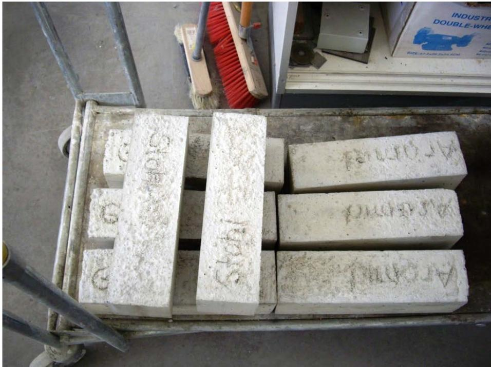
Abbildung 5.46: Proben vor dem Biegezugversuch
