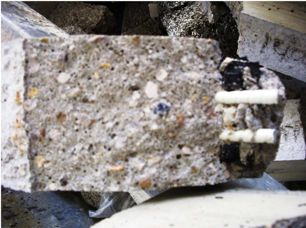
Abbildung 5.53: Glasfaserbewehrung im Gefüge nach der Zerstörung der Probe
