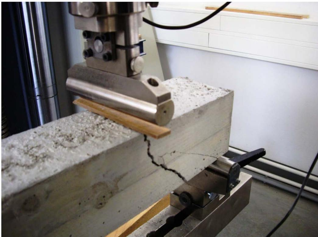
Abbildung 5.50: Zerstörte Probe mit Aramidbewehrung
