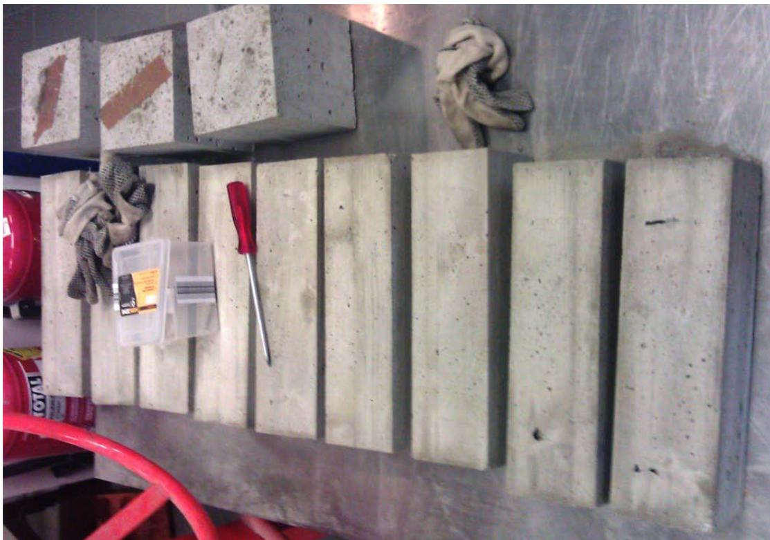
Abbildung 5.19: Ausgeschaltete Proben für Biegezugversuche mit Betonwürfeln für Druckfestigkeitsprüfung
