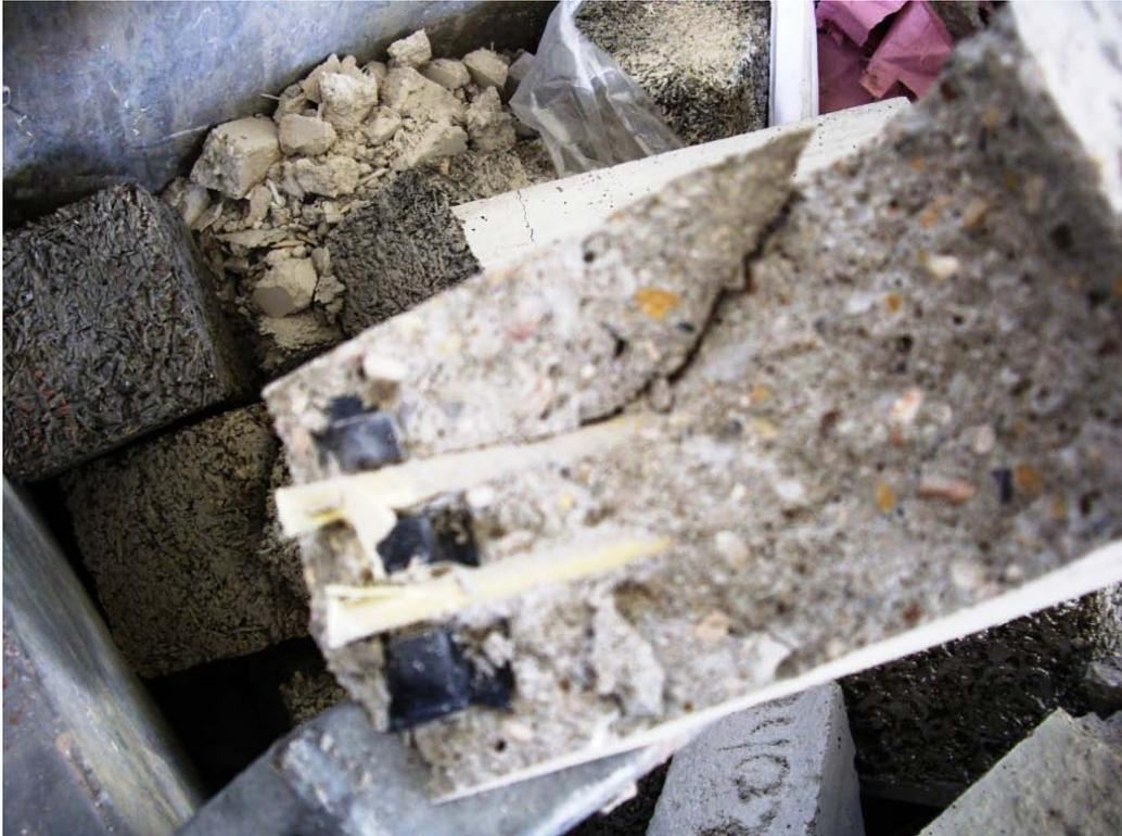
Abbildung 5.51: Aramidbewehrung im Gefüge nach der Zerstörung der Probe
