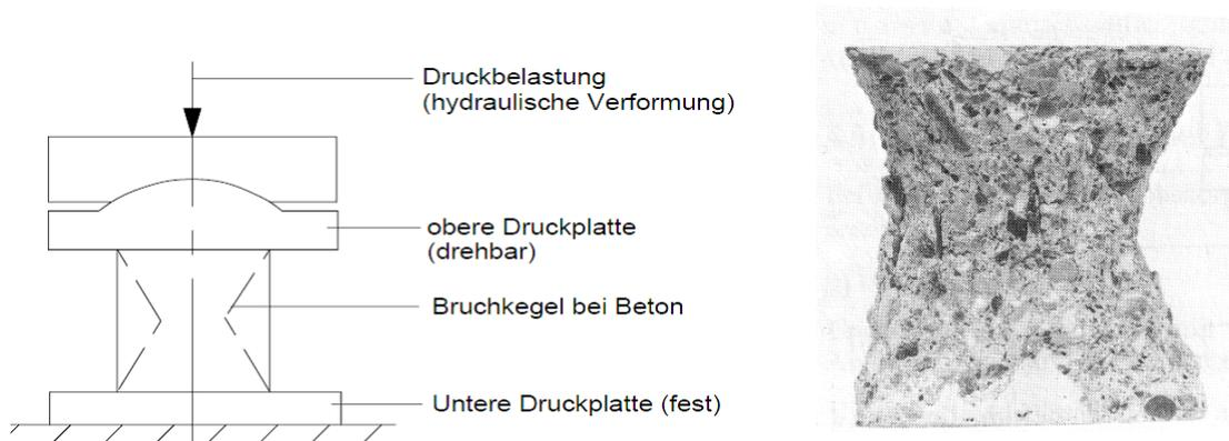
Abbildung 5.57: Druckversuch an einem Betonwürfel und ein zerstörter Betonkörper [34]
