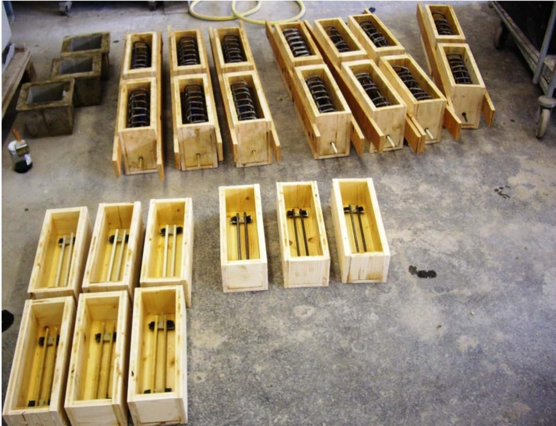
Abbildung 5.18: Zum betonieren vorbereitete Probekörper
