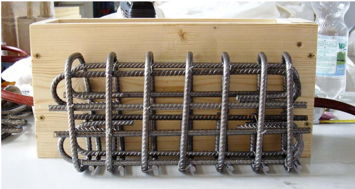
Abbildung 5.8: Fertiger Bewehrungskorb mit Schalung im Hintergrund
