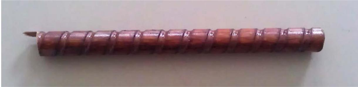
Abbildung 5.56: Probe 3 nach Brandversuch
