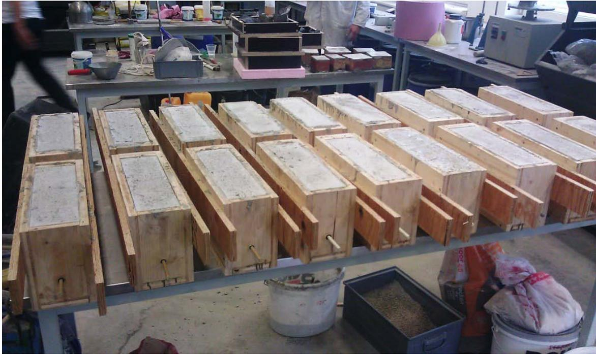
Abbildung 5.12: Proben nach dem betonieren
