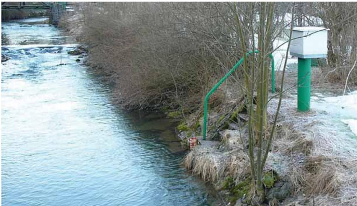
Abb. 59 Foto der Pegelmessstelle Mitterbach an der Großen Erlauf (EVN-Archiv)
