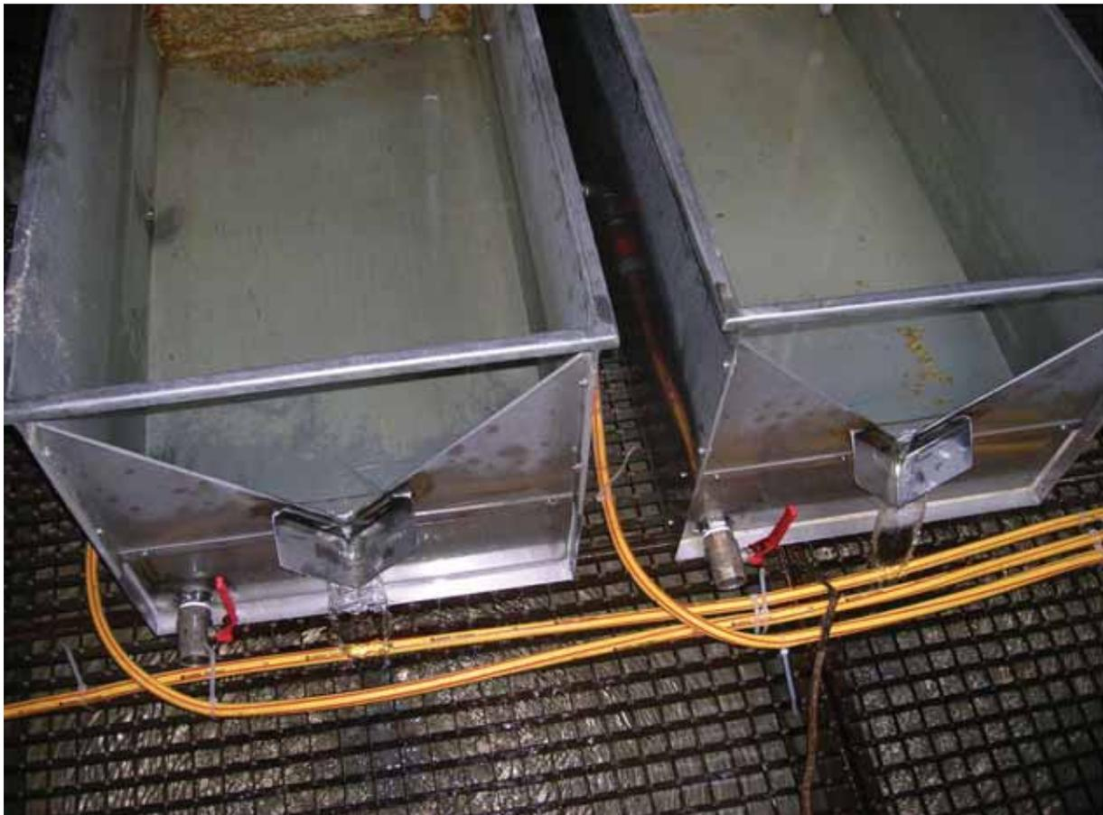
Abb. 56 Foto Sickerwassermengenmessung mit Thompsonwehren im Schacht am Dammfuß (Kozumplik, 2012)
