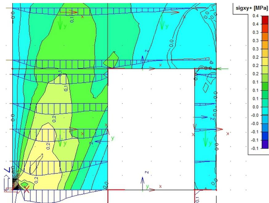
Abbildung 9.30: Schubspannungsverteilung  $\sigma_{xy}$  bei geschlossenem Rahmen aus IPE300 zufolge Last v.Rechts
