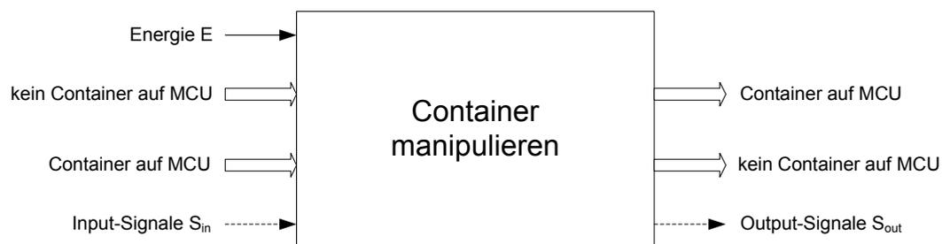
Abbildung 3.3.2.: Gesamtfunktion des Mobiler Container Umsetzer
