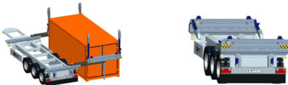
Abbildung 1.1.4.: a) Absetzen am / Aufnehmen vom Boden - b) Aufbau auf beliebiger Plattform
