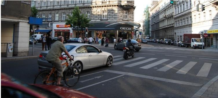
In Fahrtrichtung Zentrum nimmt eine Gehsteigauffahrt mehr als die Hälfte des Mehrzweckstreifens in Anspruch (siehe Abbildung 23). Außerdem stellt das links einordnen aufgrund der Fahrstreifenverschwenkung nach rechts für den Radfahrer eine gefährliche Herausforderung dar. Abstellanlagen sind in diesem Streckenabschnitt mehrere zu finden. Neben einem „Citybike“-Standort sind komfortabel ausgeführte Abstellbügel angebracht.
