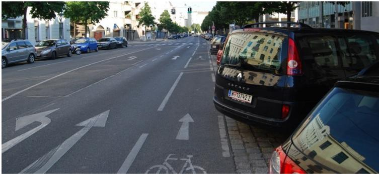
Auch in Fahrtrichtung Zentrum ist Abschnitt 4 mit einem Zielerreichungsgrad von 72 % gering bewertet, aber zumindest werden mit Ausnahme des Knotenpunktes Oberzellergasse die Mindestbreiten für Mehrzweckstreifen eingehalten. Abstellanlagen sind in dieser Fahrtrichtung jedoch nicht ausreichend vorhanden.
