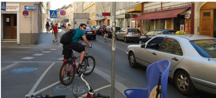
Der Mehrzweckstreifen in Fahrtrichtung Schönbrunn weist im Abschnitt 3 eine durchschnittliche Verkehrsqualität auf (77 % Zielerreichung). Die Breite der Markierung erfüllt zwar die Mindestanforderung nach RVS, überschreitet diese aber nur knapp. Außerdem kommt es aufgrund von Verkehrsbehinderungen bei den einmündenden Straßen immer wieder zu langsamen Fahrten und Stillständen. Hier wäre mehr Aufmerksamkeit der einbiegenden Kfz auf die Radverkehrsinfrastruktur zu fordern.
