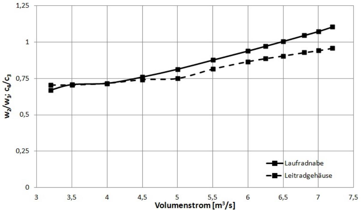
Abbildung 4.11.: Verlauf der de Haller Zahl an der Lauftradnabe und dem Leitradgehäuse
