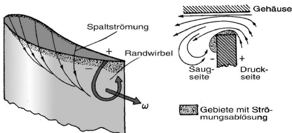
Abbildung 2.11.: Darstellung des Spaltverlustes und des Randwirbels [2]
