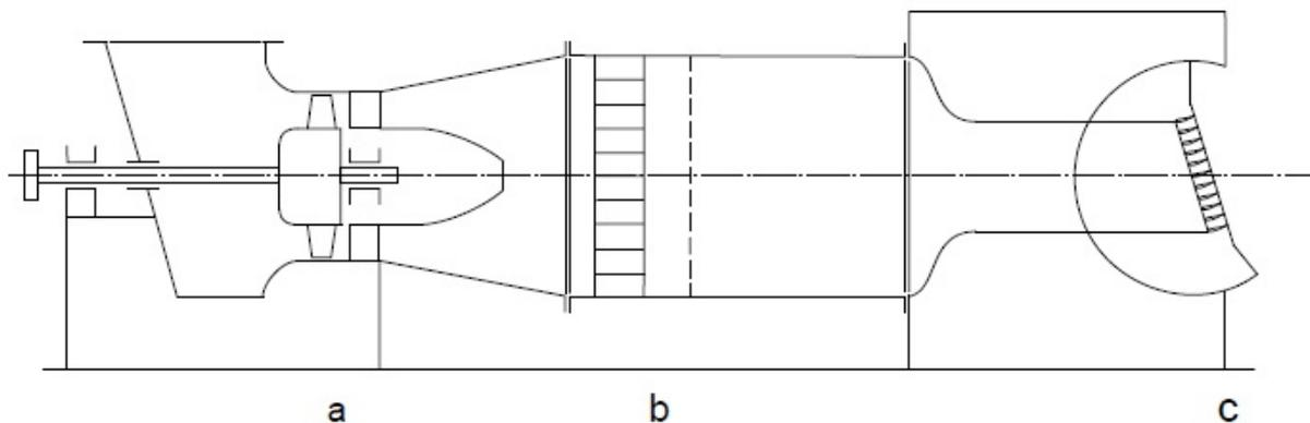
Abbildung 3.1.: Schematische Darstellung des Windkanals, a Axialventilator, b Gleichrichter, c Wiege mit Schaufelgitter [1]
