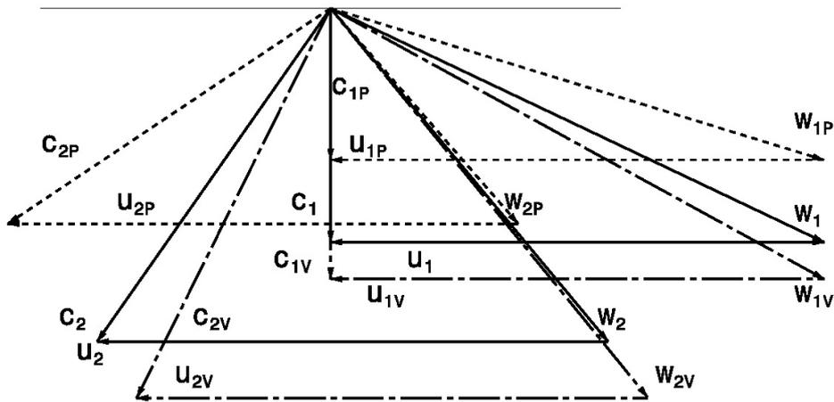
Abbildung 4.16.: Vergleich der Geschwindigkeitsdreiecke für drei Betriebspunkte (A...Auslegungspunkt, V...maximal berechenbarer Volumenstrom, P...Pumpgrenze)
