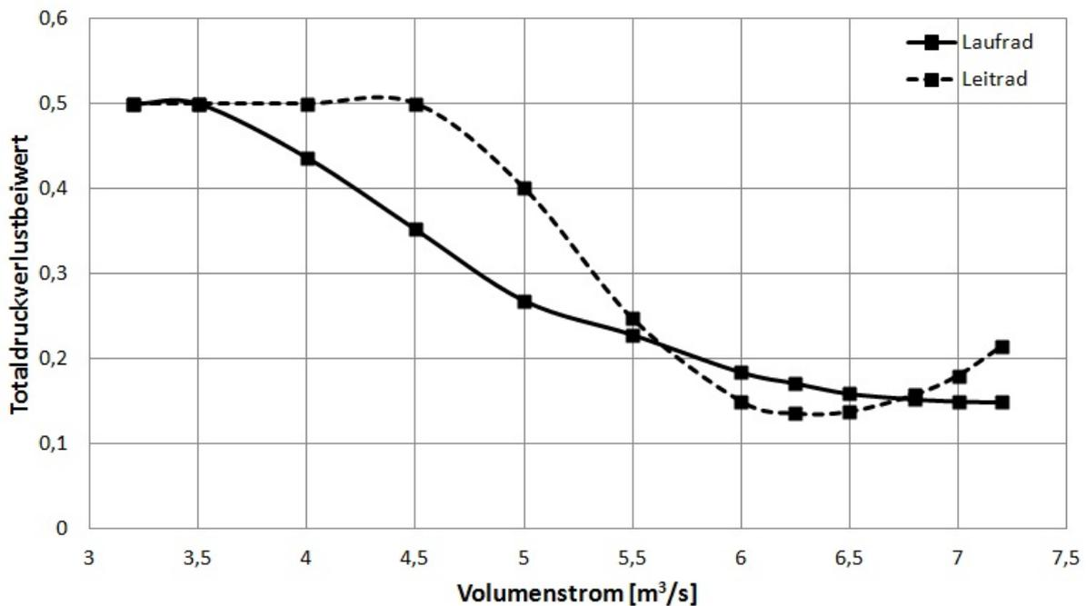
Abbildung 4.12.: Verlauf des Totaldruckverlustbeiwerts an der mittleren Meridianstromlinie
