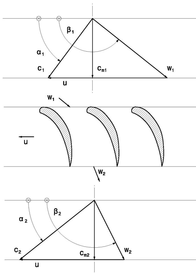
Abbildung 2.1.: Geschwindigkeitsdreiecke
