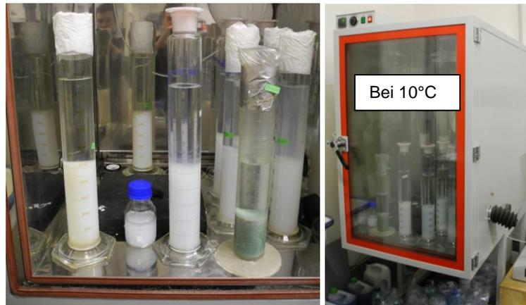
Abbildung 50: Standversuch zur Bestimmung des Schrumpfungsverhaltens über die Zeit
