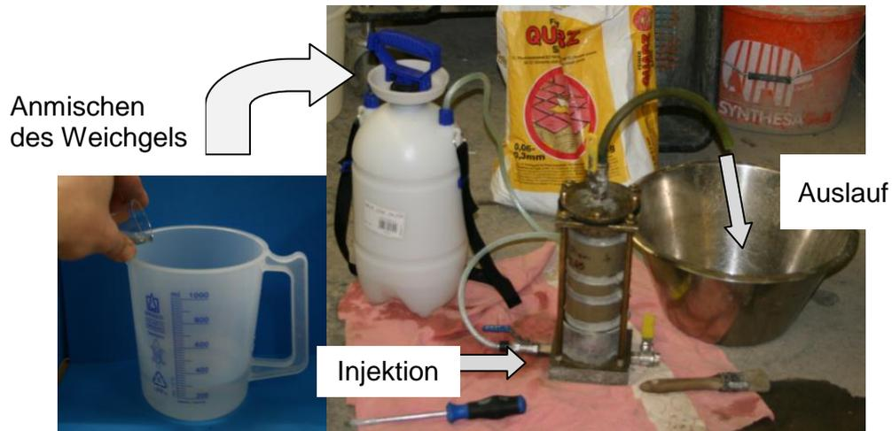
Abbildung 62: Injektion in die Probe
