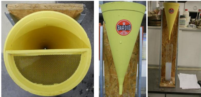
Abbildung 42: Marsh-Trichter nach DIN V 4126-100
