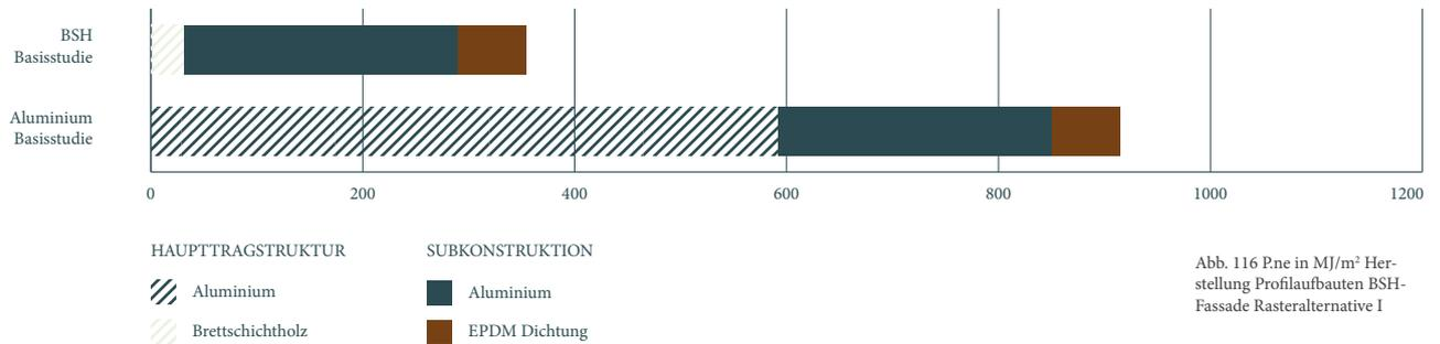
Abb. 116 P.ne in MJ/m<sup>2</sup> Herstellung Profilaufbauten BSH-Fassade Rasteralternative I
