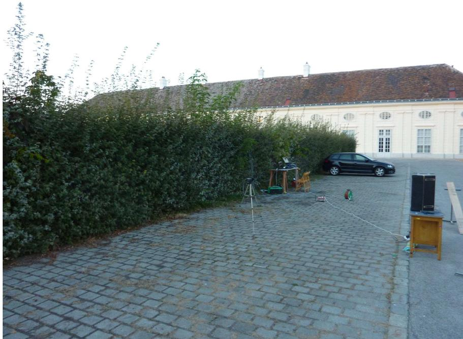
Anhang 15: Schallquelle und Referenzmikrofon vor der Hecke mit Belaubung
