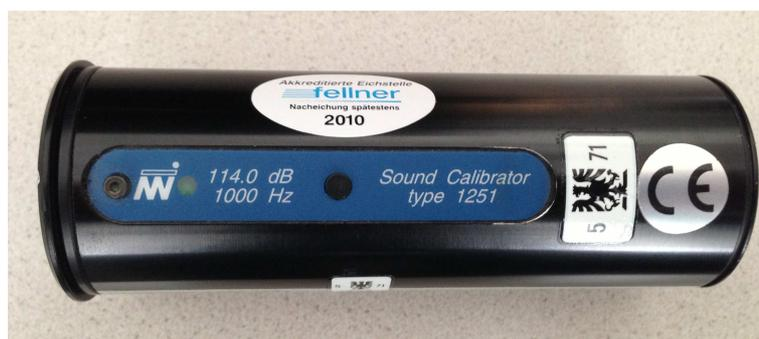
Abbildung 4.3: verwendeter Kalibrator Norsonic 1251
