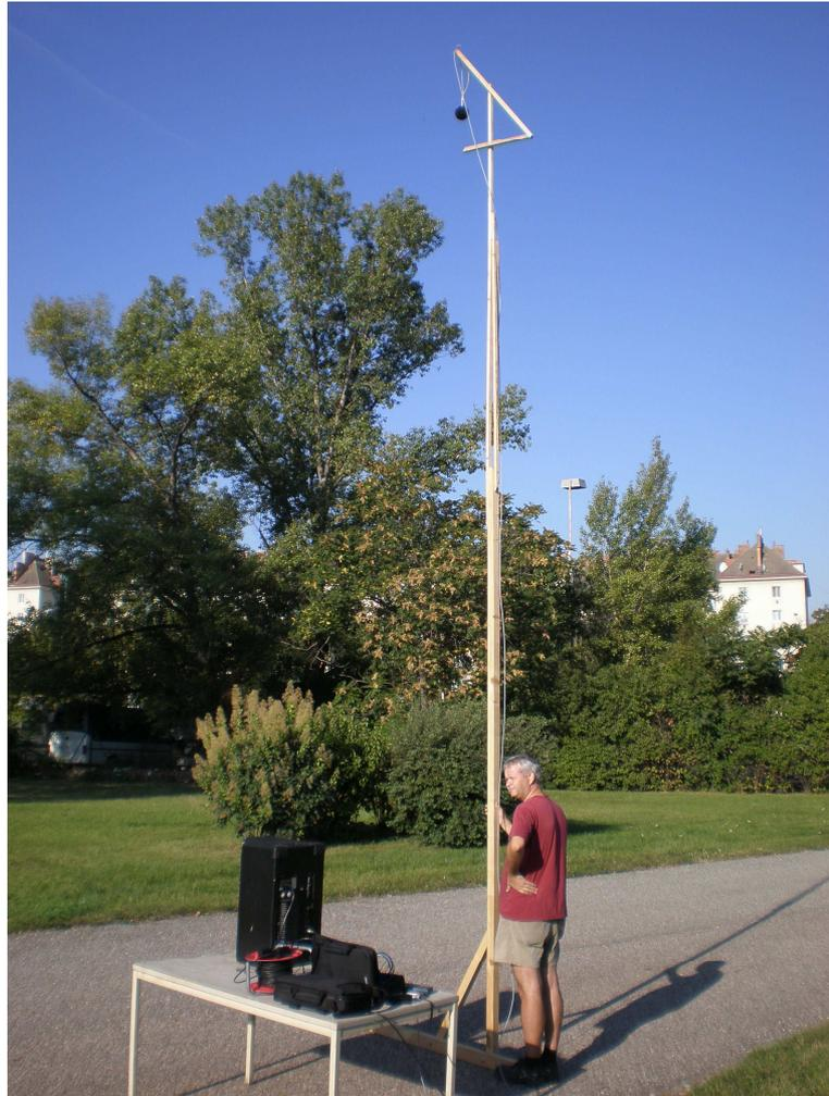
Anhang 3: Messung zur Bestimmung der vertikalen Richtcharakteristik oben
