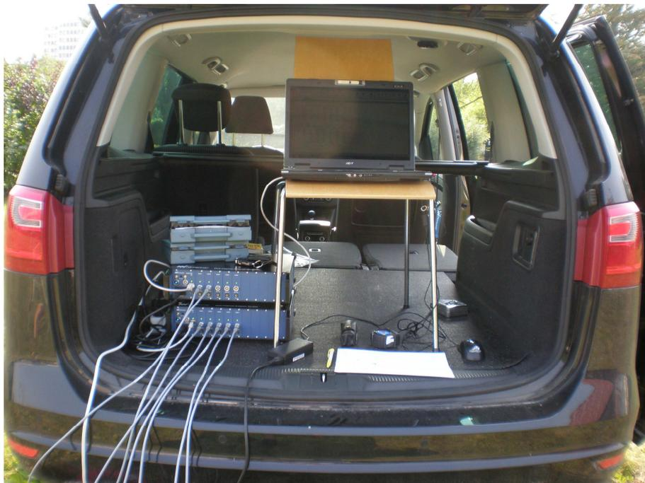
Anhang 2: Messsystem bei den Messungen der horizontalen Richtcharakteristik
