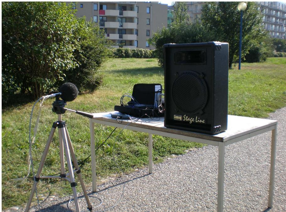
Abbildung 4.4: gerichteter Aktivlautsprecher (Schallquelle) und Freifeldmikrofon mit Windscreen
