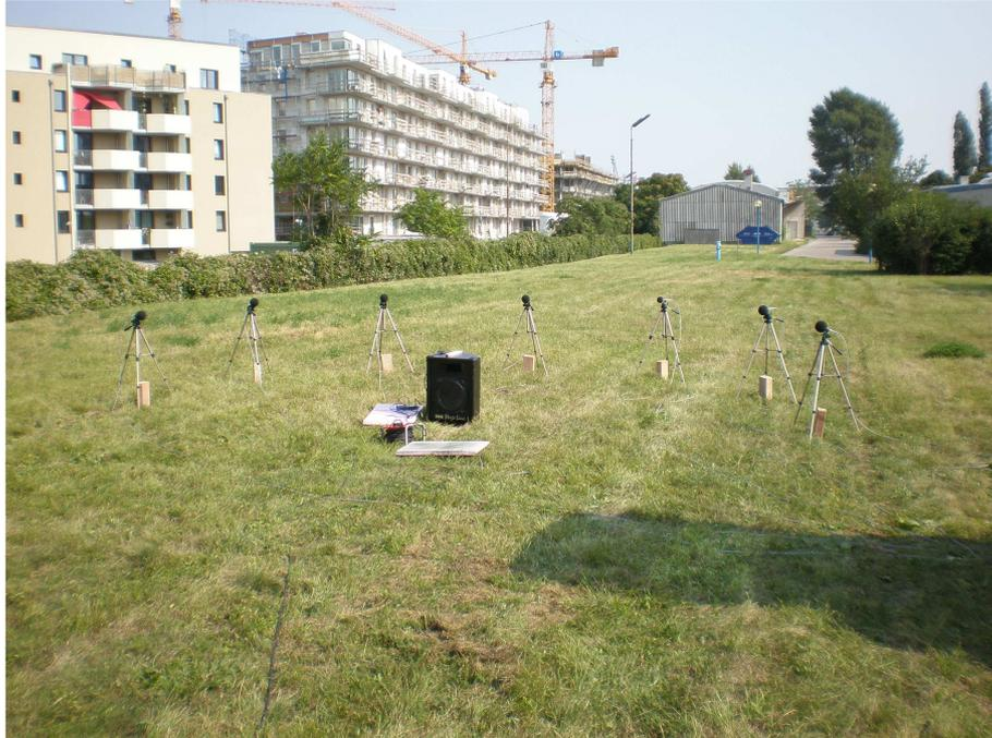
Anhang 1: Messaufbau zur Bestimmung der horizontalen Richtcharakteristik
