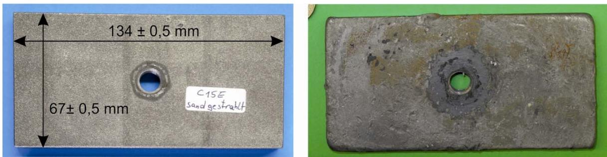
Abbildung 5-5: Drehflügel des TU Wien Abrasimeters. Links: vor Versuchsdurchführung mit Abmessungen und Toleranzen, rechts: nach Versuchsdurchführung [32].
