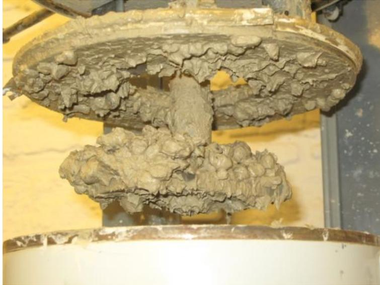
Abbildung 6-7: Aufostrung und Drehflügel nach Durchführung eines TU Wien Abrasimeterversuchs mit quartärem Donauschotter der Korngröße 8 – 16 mm des aus dem Marchfeld [35].
