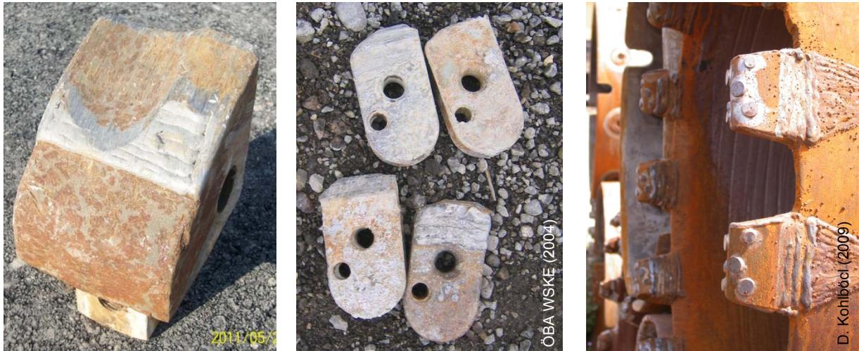
Abbildung 1-1: Typische Verschleißerscheinungen an Werkzeugen des Spezialtiefbaus. Links: Schälmesser eines TVM-Schneidrads [33]. Mitte: Fräszähne einer Schlitzwandfräse. Rechts: Schneidschuh einer Bohrfahlverrohrung.
