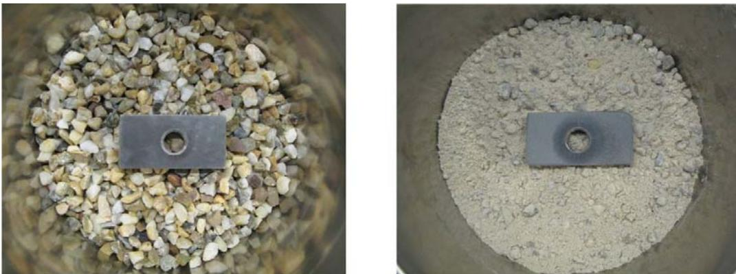
Abbildung 3-3: Bodenprobe und Drehflügel vor (links) und nach (rechts) einem LCPC-Versuch [35].
