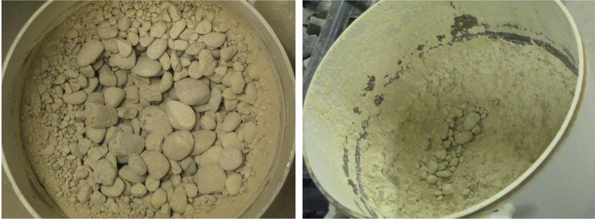
Abbildung 5-7: Links: Entmischung einer trockenen Bodenprobe infolge Rotation des Drehflügels. Rechts: Kompakte Matrix am Topfrand und -boden, welche – nach Abkippen der losen Probenbestandteile – nicht durch ihr Eigengewicht aus dem Behälter fällt.
