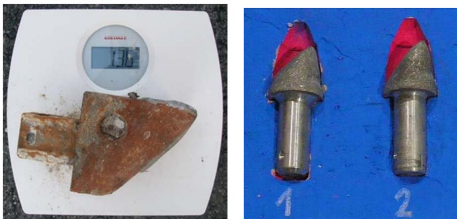
Abbildung 7-7: *Detaillierte Verschleißdokumentation auf der Baustelle. Links: Gewichtsmessung eines ausgetauschten Schälmessers [33]. Rechts: Abgenutzte Bohrmeißel in Schablone [42].*
