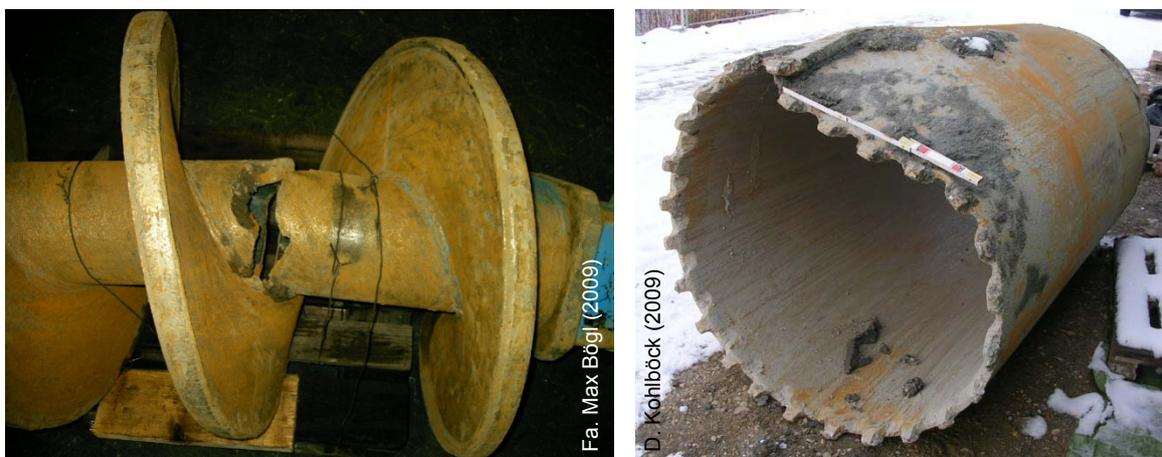
Abbildung 7-1: *Kein Abrasivverschleiß. Links: Infolge Überbeanspruchung gebrochenes Schneckenbohrgestänge. Rechts: Durch ein Hindernis beschädigte Bohrfahlverrohrung.*
