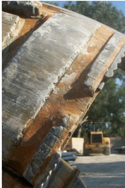
Abbildung 7-2: *Seitenansicht eines verschlissenen Räumers am Schneidrad einer Tunnelvortriebsmaschine mit suspensionsgestützter Ortsbrust.*
