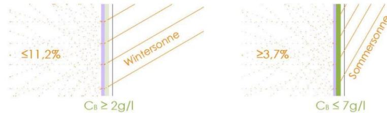
Abb. 4.25: schematische Darstellung der Tageslichtoptimierung durch Verschattung und Lichtleitung. Variierende Biomassekonzentration im Jahresverlauf steuert die Verschattungswirkung.
