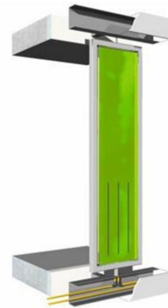
Abb. 3.4: PBR-Fassadenelement © Arup Deutschland GmbH [dbz 2012]
