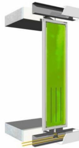
Abb. 4.23: PBR-Fassadenelement mit Zu- und Ableitung an der Drehachse [dbz 2012] ©Arup GmbH
