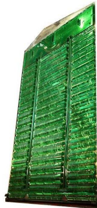
Abb. 2.13: Flachplatten-Airlift-Reaktor der Firma Subitec [Subitec 2013]
