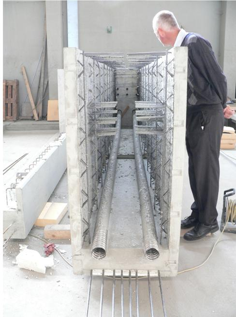
Abbildung 23: Herstellung der Bodenplatte des Trogquerschnitts
