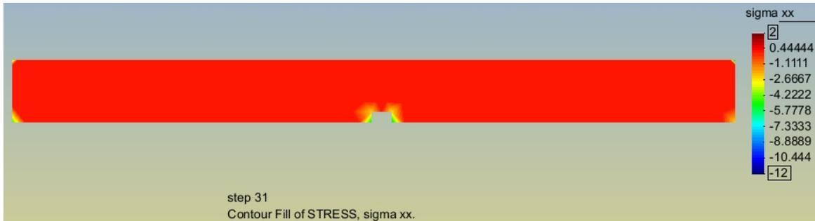
Abbildung 73: Spannungsverlauf im Füllbeton bei step 31,  $T = 48,23 d$
