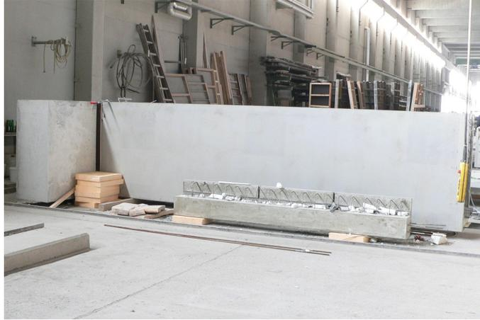
Abbildung 24: Trogquerschnitt mit Querträger
