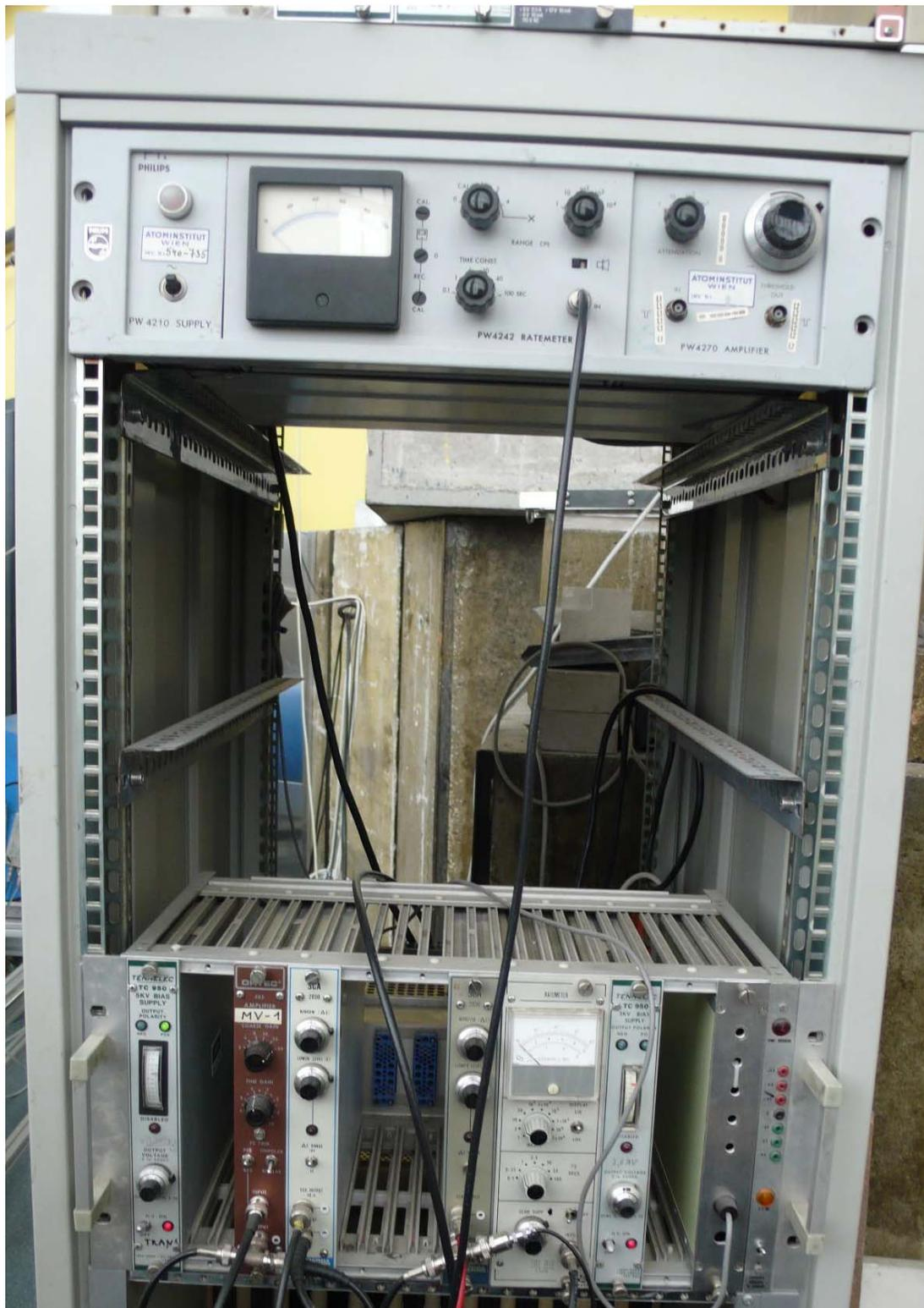
Abbildung B.2.: Oben ist das Ratemeter abgebildet. Unten von links nach rechts: Hochspannungsversorgung, Verstärker und Singlekanalanalysator für den  $^3\text{He}$ -Detektor; Singlekanalanalysator für den  $\text{BF}_3$ -Detektor; das Ratemeter gehört nicht zur USANS-Anlage; Hochspannungsversorgung für den  $\text{BF}_3$ -Detektor.
