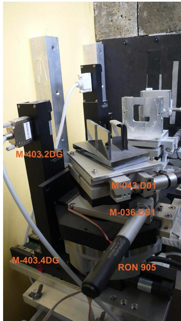
Abbildung B.4.: Der Aufbau des Analysatorsystems: M-043.4DG und M-403.2DG übernehmen horizontale und vertikale Translation, M-036.DS1 ist eine Drehachse und M-043.D01 dient der Verkippung des Kristalls. RON 905 ist das Winkelmessgerät.
