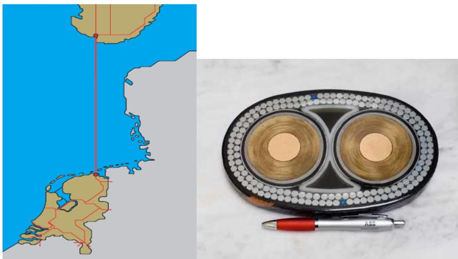
Abbildung 39: Verlauf und Querschnitt des NorNed-Kabels; Quelle: (Statnett, TenneT, 2008), (Johnstone, 2009)
