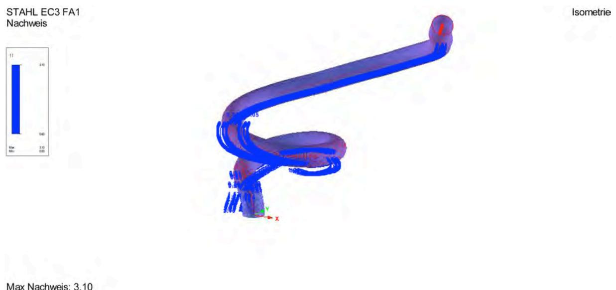
Abb. 90: Grafische Darstellung der Torsionsfestigkeit am Beispiel von Element „RF6“
