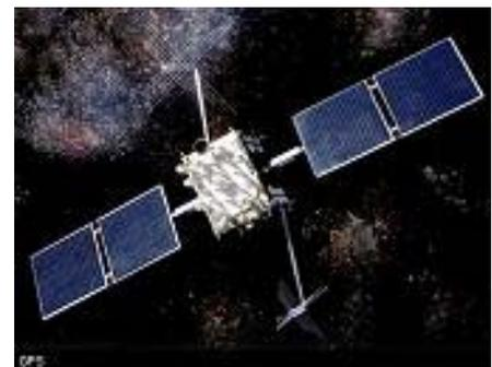
Abb.4.1a: GPS Satellit vom Typ Block IIR
